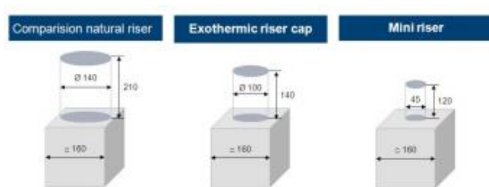
Obr. 25 Porovnání přirozeného, exotermického a mini-nálitku [10].
