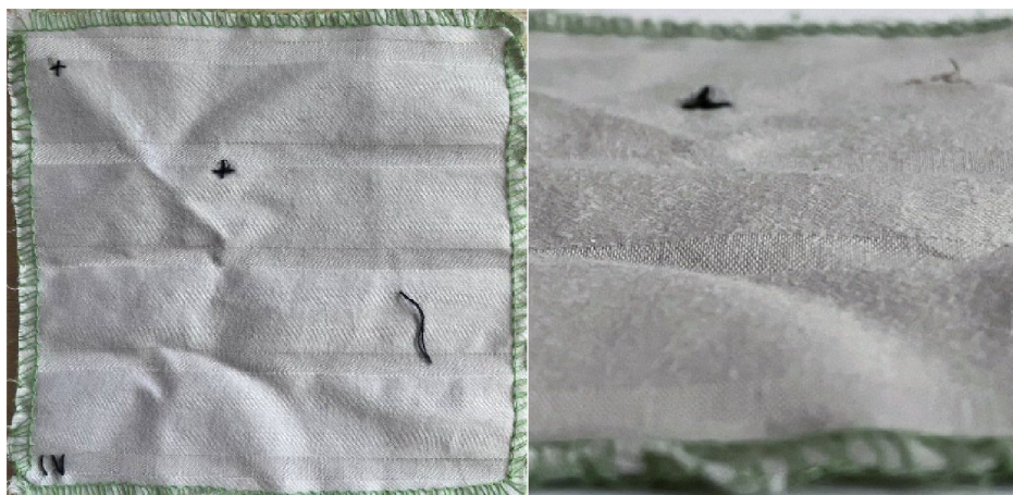
Obrázek 21: Vzorek V 4 po 10 pracích cyklech + mechanické poškození kartáčem a následné praní 1 pracím cyklem: vlevo je celkový pohled, vpravo je detailní pohled
