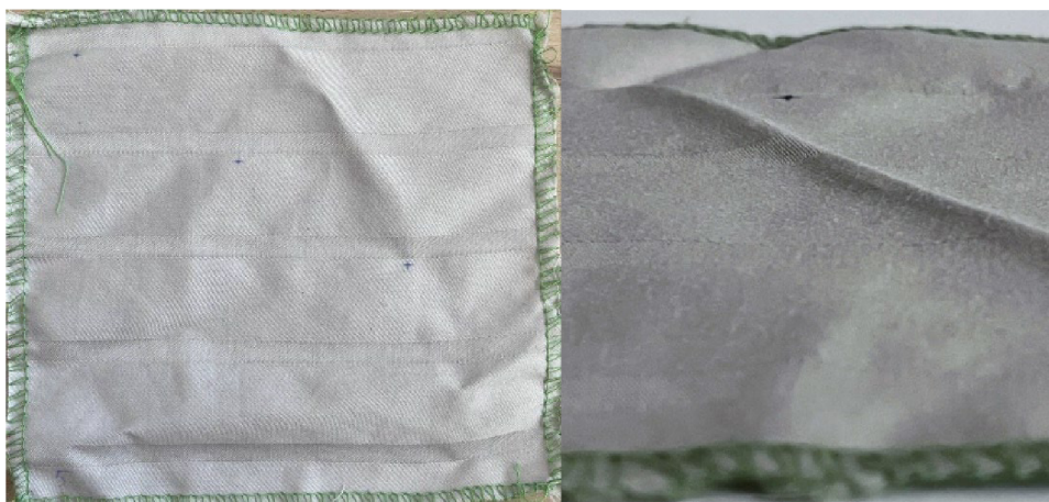
Obrázek 22: Vzorek V 5 po vyprání 1 pracím cyklem se suchým zipem + 3 pracích cyklech: vlevo je celkový pohled, vpravo je detailní pohled
