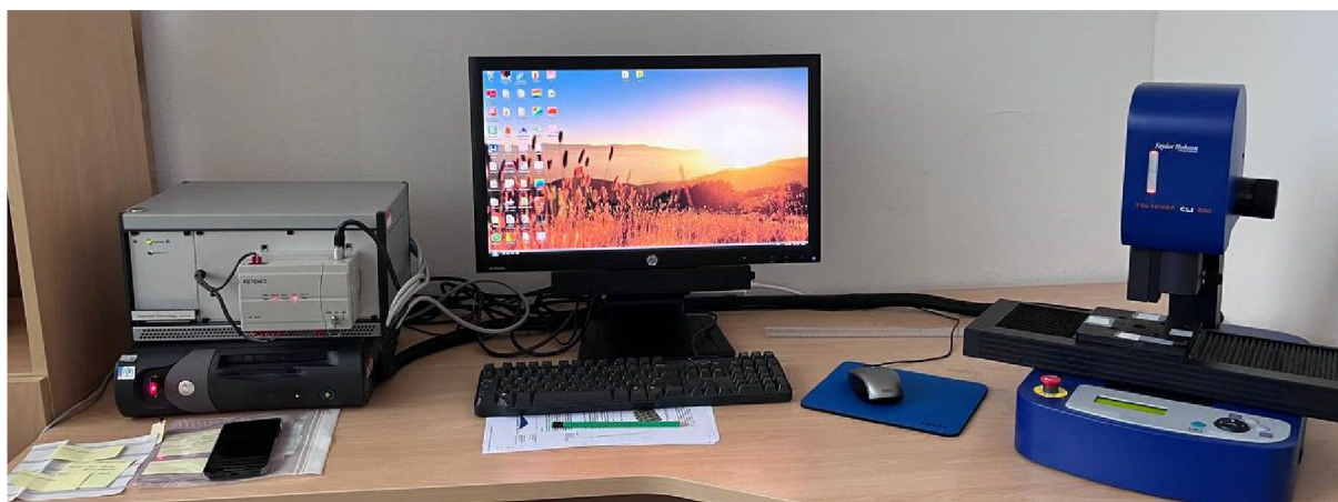
Obrázek 24: Měřicí sestava Talysurf CLI 500 (včetně PC a řídicí jednotky)
