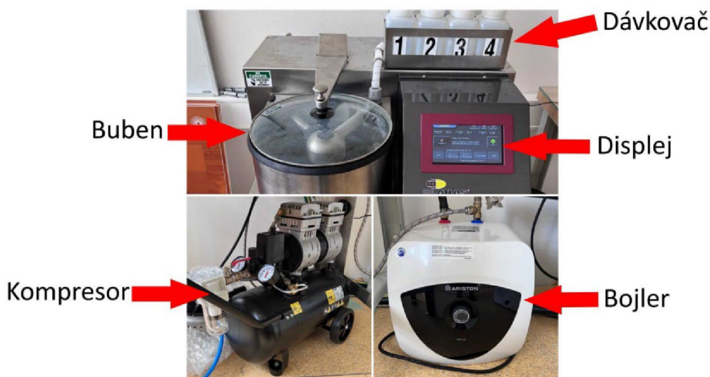
Obrázek 9: Popis hlavních částí Quickwash M222QW a přídatného vybavení.
