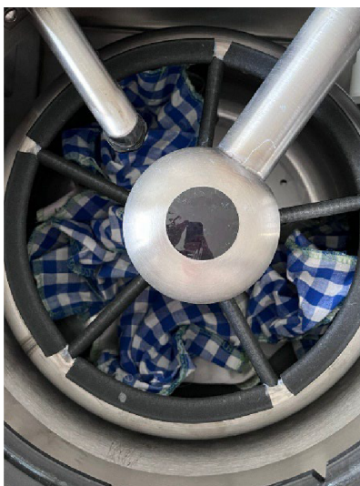
Obrázek 15: Umístění vzorků do komůrek pracího bubnu pračky
