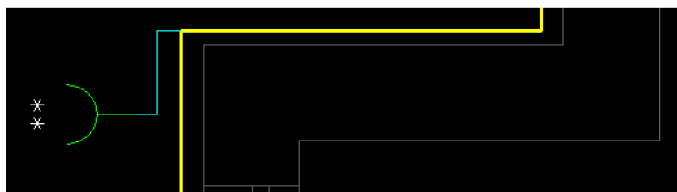
Obr. B.31: Príklad nevhodného napojenia káblu na káblovú trasu
