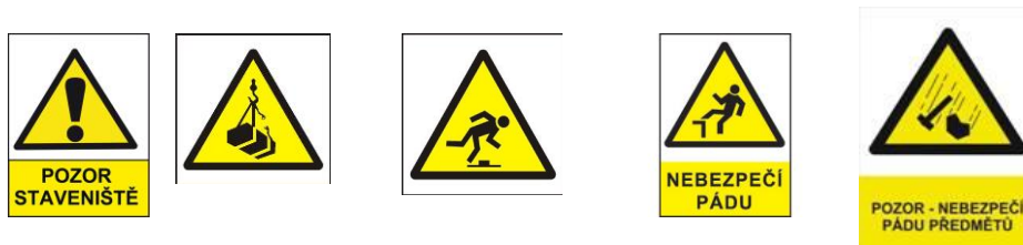
Obr. 53 - Značky upozorňující na nebezpečí při pohybu stavbě
