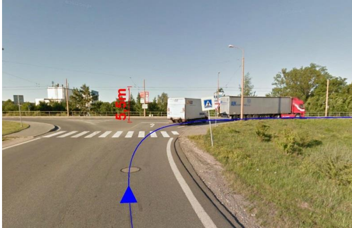
Obr. 18 - Schéma průjezdné výšky soupravy pod trolejovým vedením
