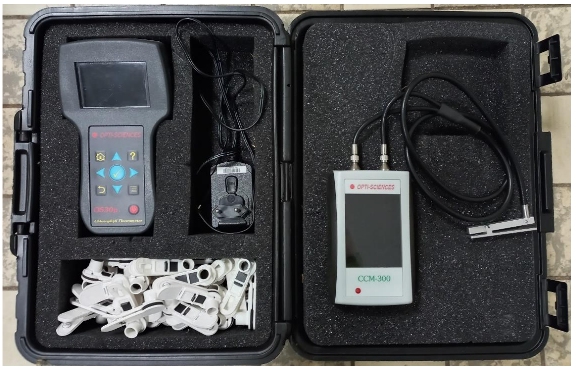
Obr. 5: Vlevo se nachází přenosný přístroj Opti-Sciences OS30p+ na měření fluorescence chlorofylu i se zatemňovacími svorkami používanými na adaptaci vzorku na tmu. Vpravo je umístěn přístroj Opti-Sciences CCM-300 sloužící k měření koncentrace chlorofylu.
