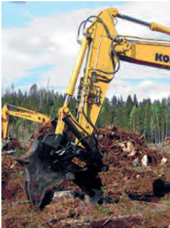
Obrázok 2: Pallari stump harvester-nadstavec na vytrhávanie pňov. [TRENČIANSKY et al., 2007]
