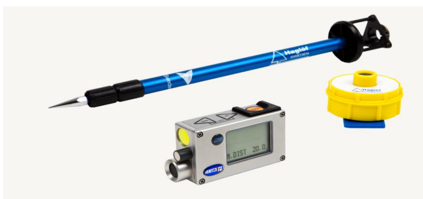
Obrázok 10: Výškomer Vertex s transpondérom a statívom transpondéru.
