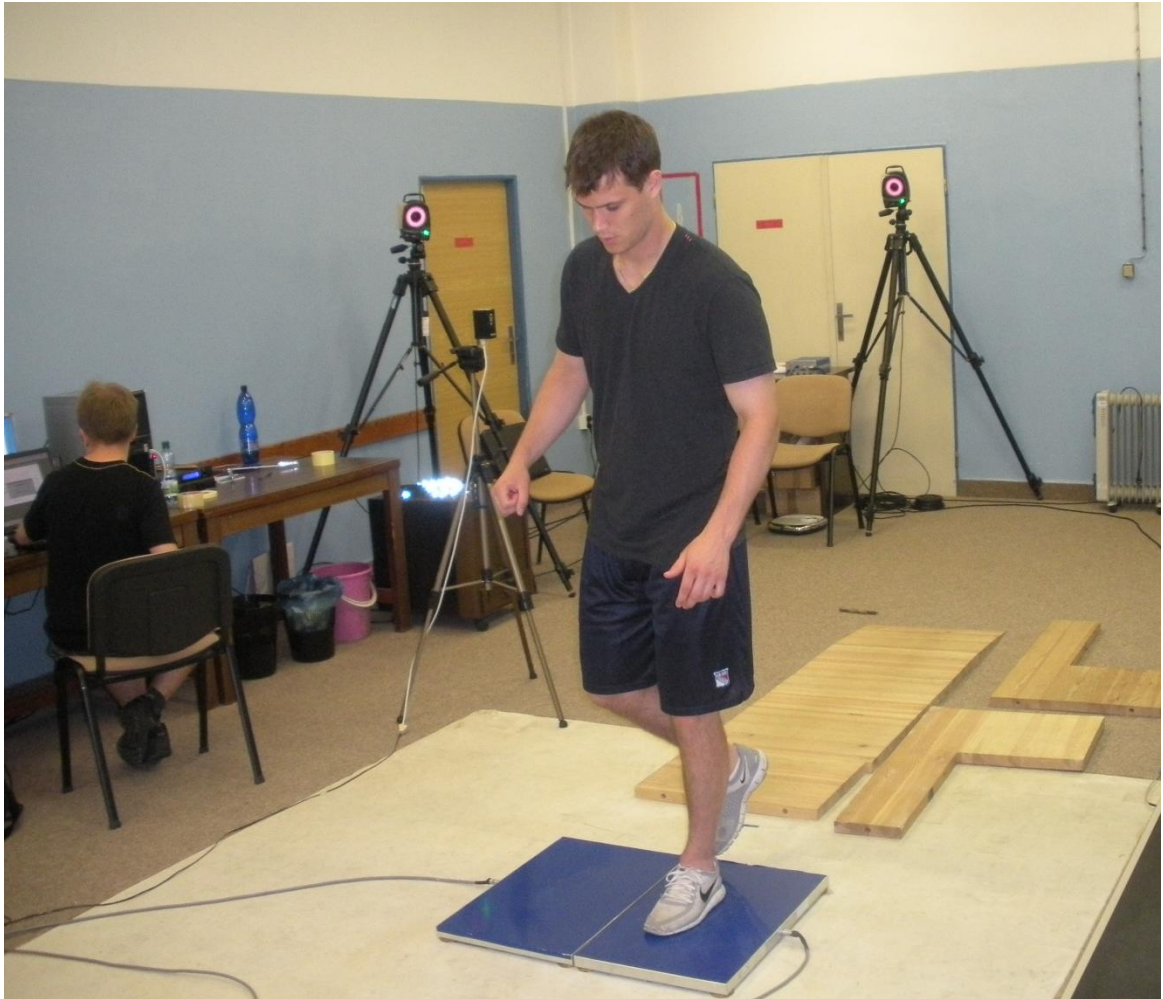
Obrázek 13. Testování na plošině Kistler typ: 9286AA (Kistler Instrumente, Winterthur, Switzerland)
