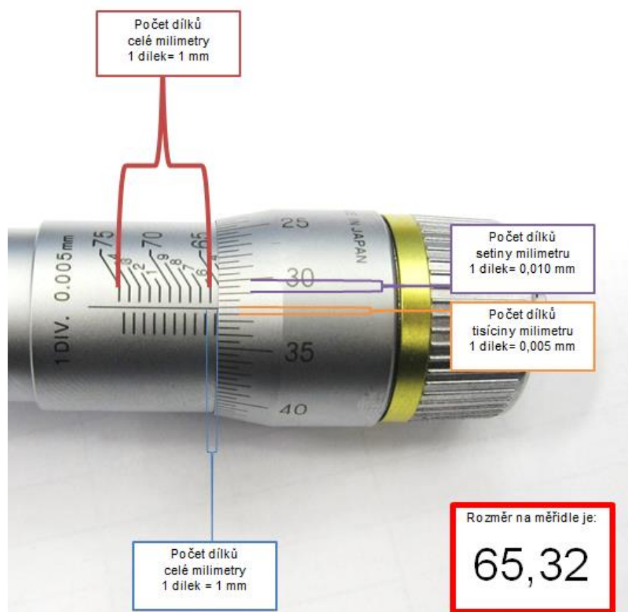
Obr. 10 Postup při odečítání z analogové stupnice
