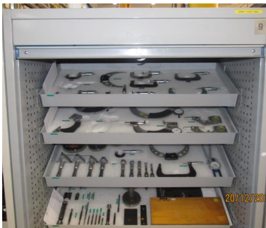
Obr. 8 Uložení měřidel u stroje MORI SEIKI NL 2500
