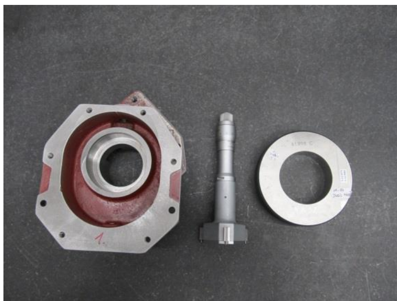
Obr. 20,21 Vybraný analogový dutinoměr a měřený díl
