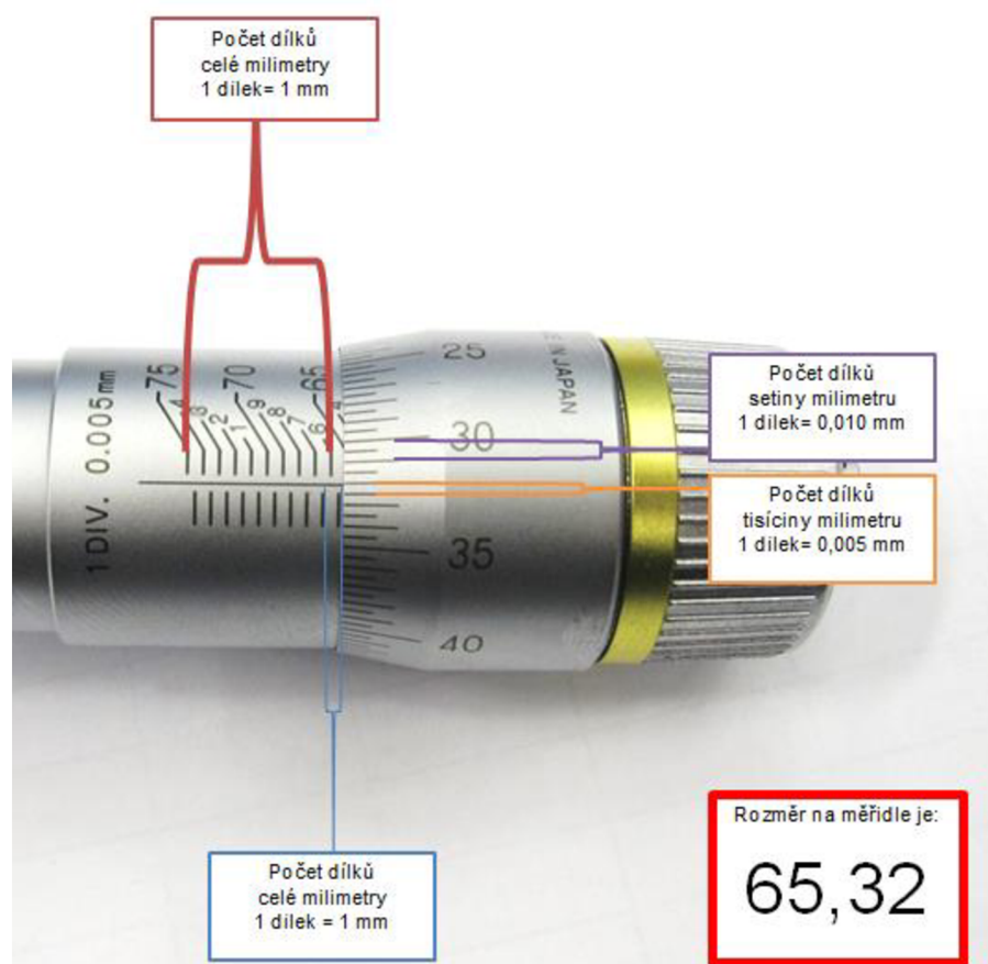
Obr. 10 Postup při odečítání z analogové stupnice
