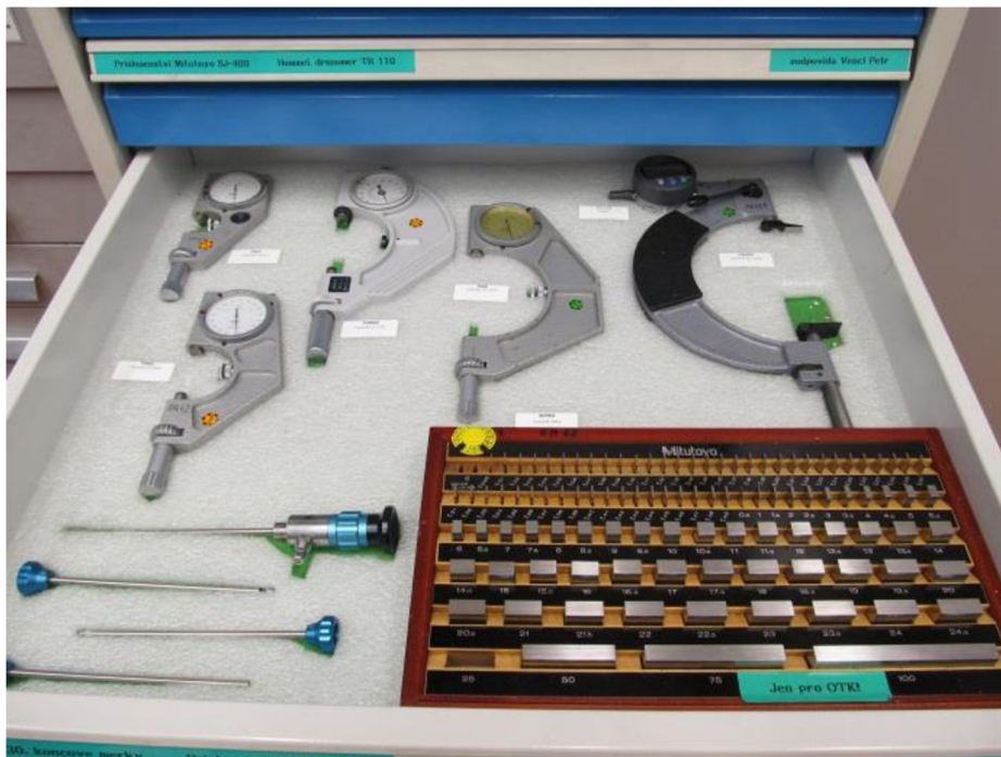
Obr. 25 Uložení pasametru a koncových měrek
