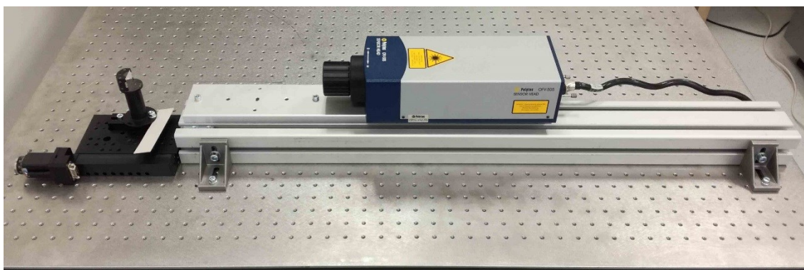
Obrázek B.2: Měření vlastního šumu vibrometru OFV-505/5000
