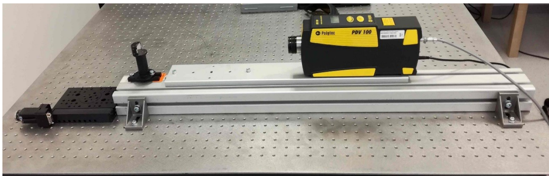
Obrázek B.1: Měření vlastního šumu vibrometru PDV-100
