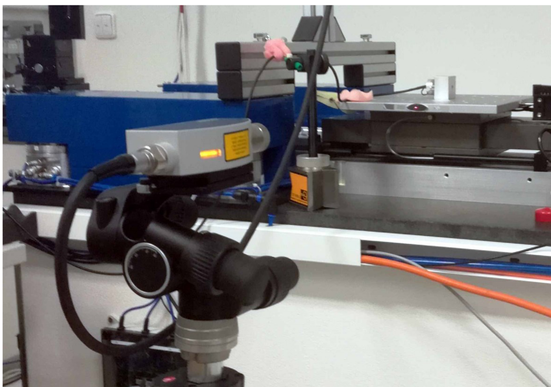
Obrázek B.5: Měření koherenčního šumu pomocí vibrometru CLV-2534
