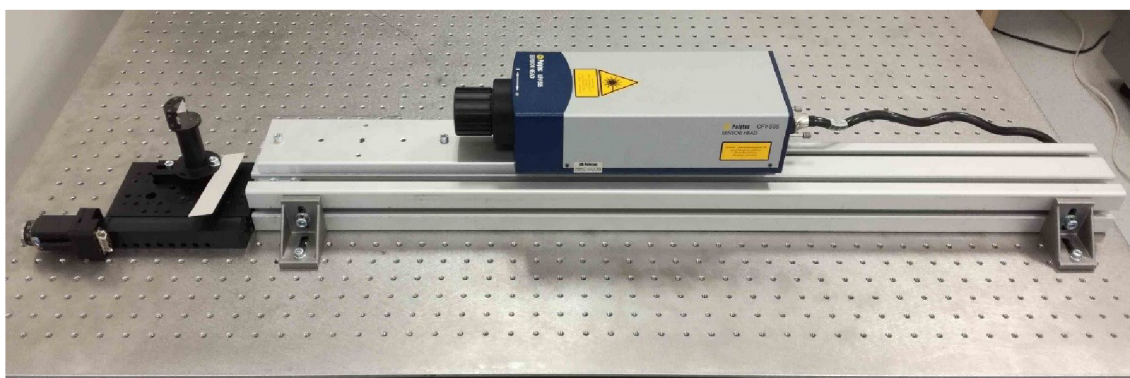
Obrázek B.2: Měření vlastního šumu vibrometru OFV-505/5000
