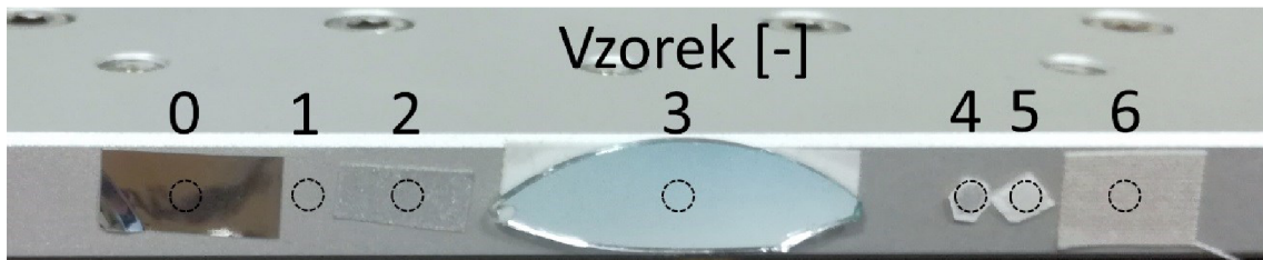
Obrázek 4.14: Měřené vzorky a místa měření z hlediska koherenční zrnitosti
