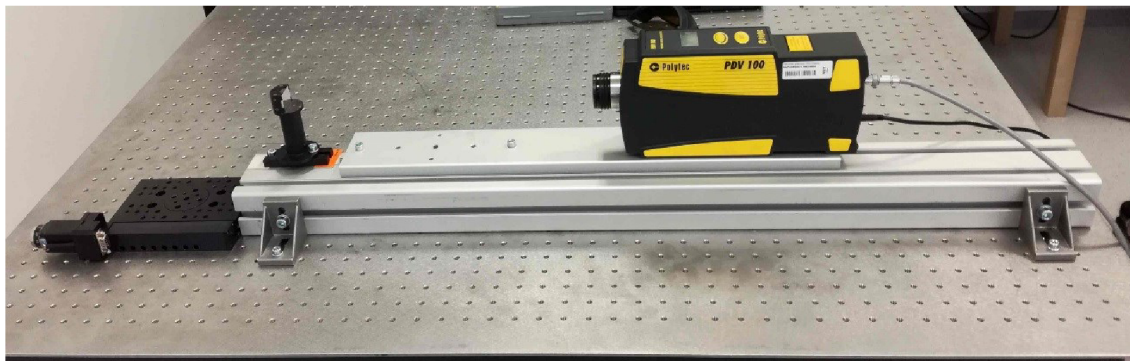
Obrázek B.1: Měření vlastního šumu vibrometru PDV-100
