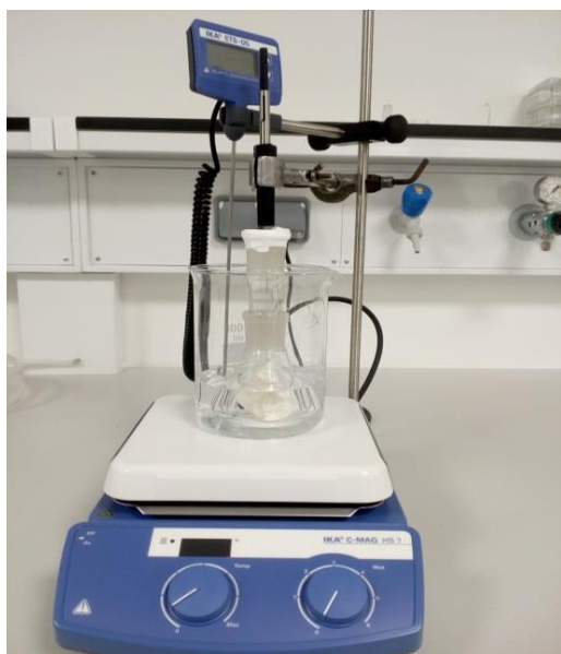
Obr. č. 11. Proces extrakce pomocí HS-SPME (Beránková 2018).
