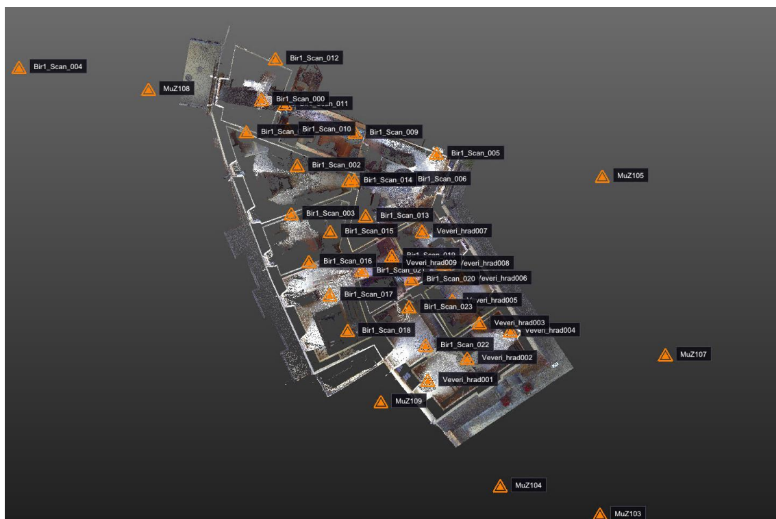
Obrázek 10 – Rozmístění stanovišek laserového skeneru
