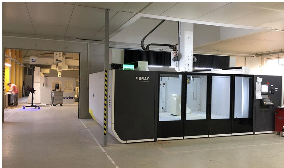
Obrázek 5: Frézovací fréza - BRAY FC 3022 - 5X Zdroj: interní materiály společnosti
