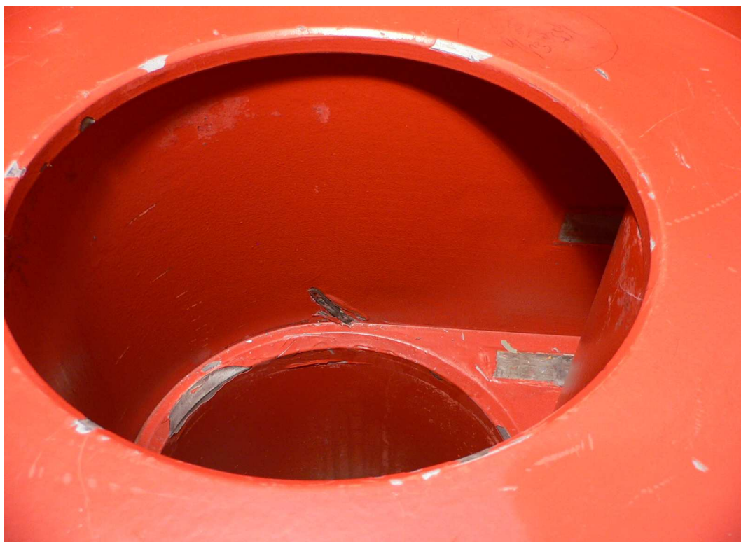
Nalezený úlomek z čidla KNI o PED = 1 Sv/hod. (Zalisovaný do nátěru)
