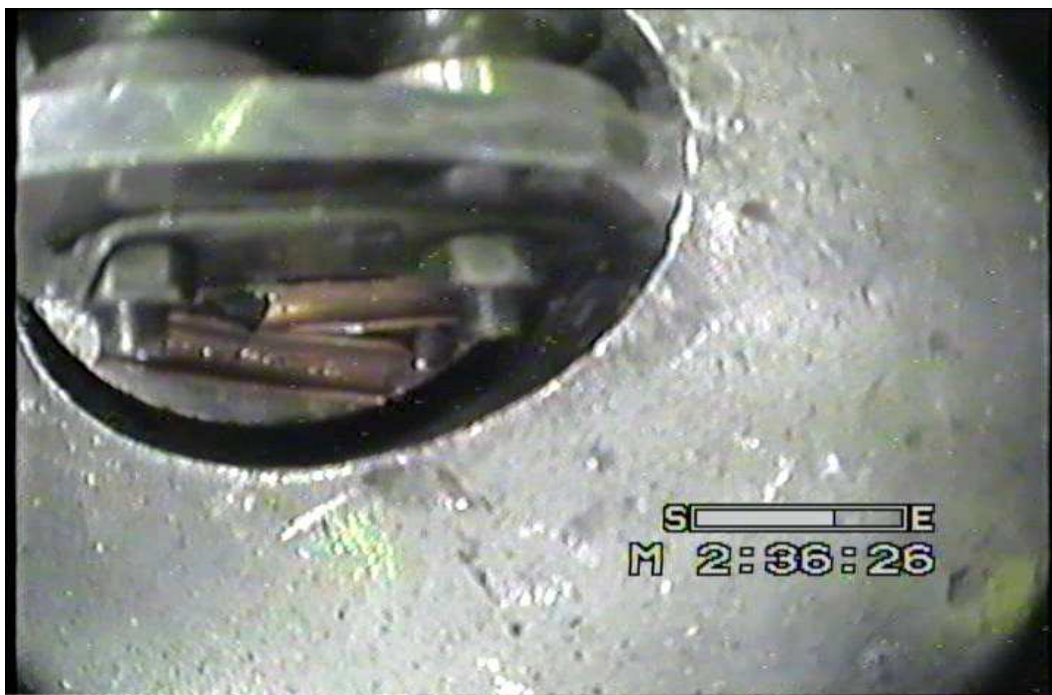
Úlomky čidla vedle čepů rovnacích kladiček
