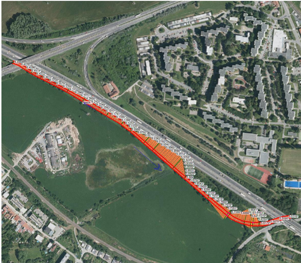
Obr. 45 Simulace úseku toku v programu HEC-RAS, MO_LES_008
