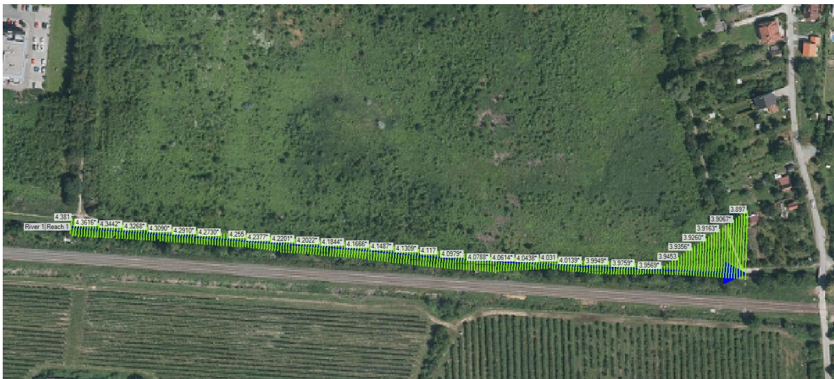
Obr. 40 Simulace úseku toku v programu HEC-RAS, MO_LES_006
