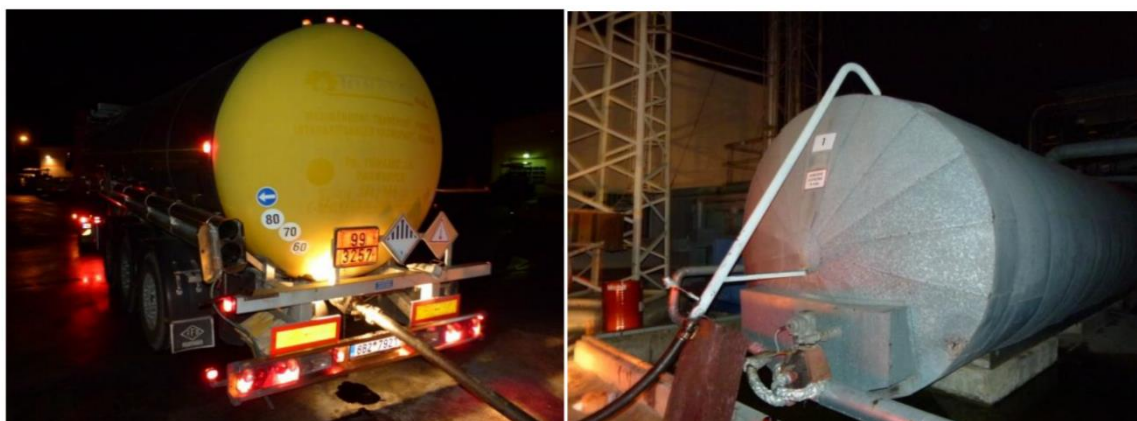
Obrázok 12: Prečerpávanie asfaltu modifikovaného gumovým granulátom do zásobníka asfaltu obalovne
