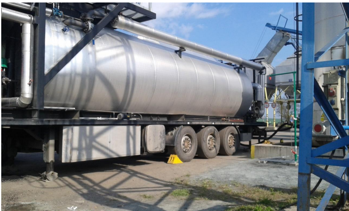
Obrázok D3: Zaistenie mobilného miešacieho zariadenia-blender
