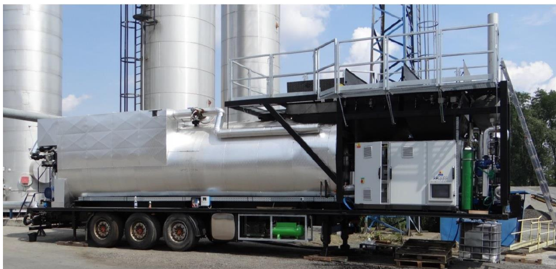
Obrázok 10: Mobilné miešacie zariadenie (blender) určené pre výrobu CRmB
