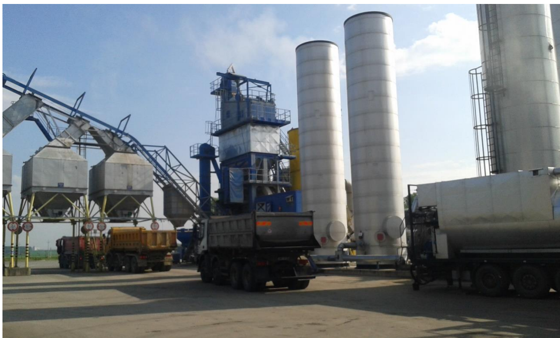
Obrázok D4: Dávkovanie zmesi s CRmB do korby nákladného vozidla
