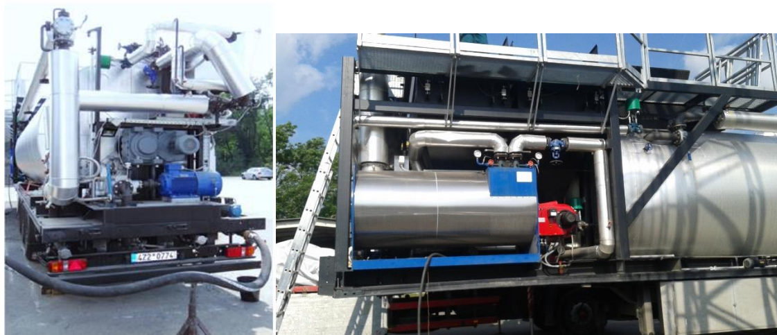
Obrázok 11: Miešacie zariadenie blender na výrobu asfaltového spojiva modifikovaného gumovým granulátom
