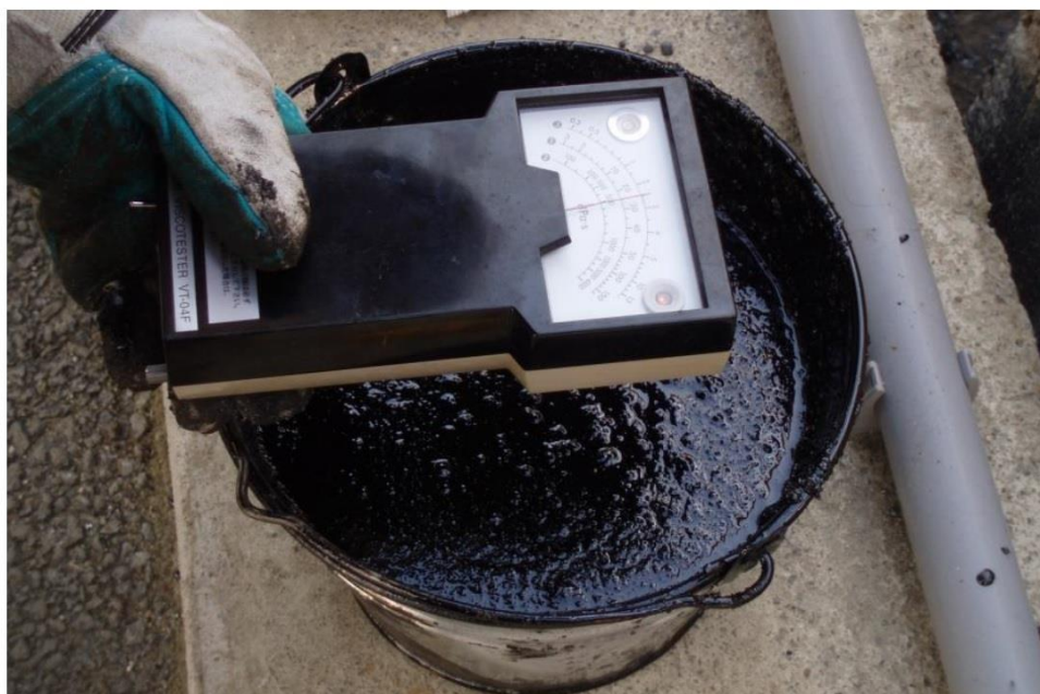
Obrázok 13: Meranie dynamickej viskozity rotačným vretenovým viskozimetrom
