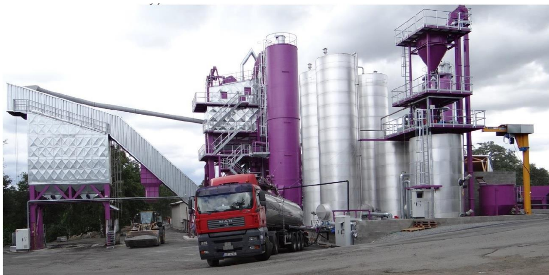
Obrázok 8: Stacionárne miešacie zariadenie (blender) určené pre výrobu CRmB
