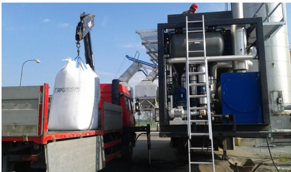
Obrázok 10: Mobilné miešacie zariadenie (blender) určené pre výrobu CRmB
