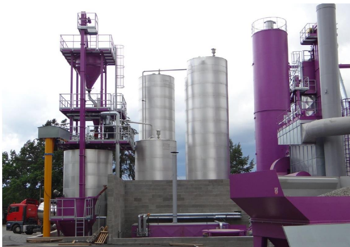
Obrázok 9: Stacionárne miešacie zariadenie (blender) určené pre výrobu CRmB
