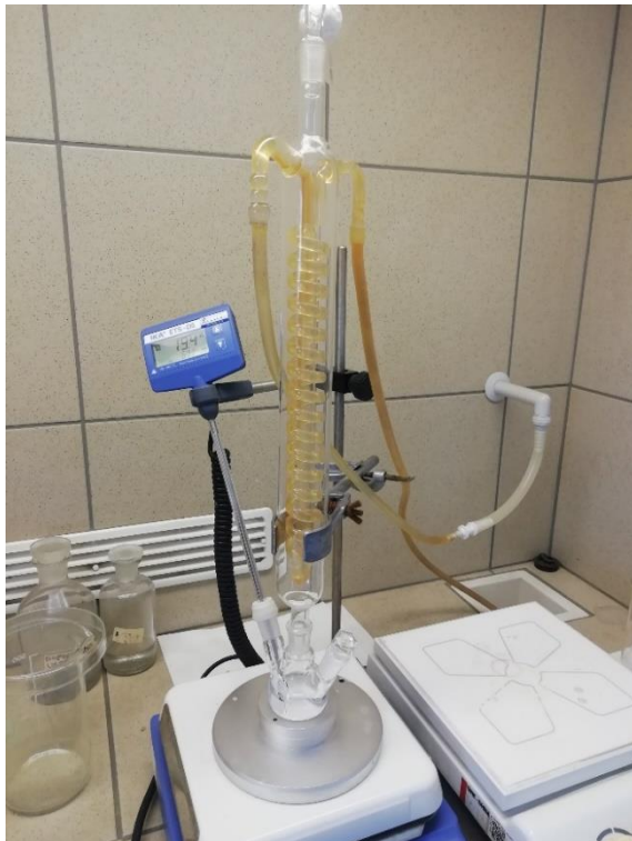
Obrázek 10 Aparatura pro přípravu zárodečného roztoku (vlevo), zárodečný roztok ZnO (vpravo)
