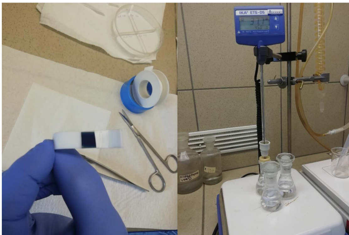
Obrázek 13 Substrát připevněný na plastový držák (vlevo), příprava růstového roztoku metodou CBD (Vpravo)
