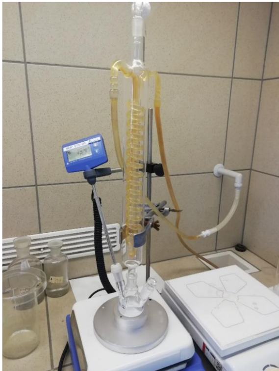
Obrázek 10 Aparatura pro přípravu zárodečného roztoku (vlevo), zárodečný roztok \text{ZnO} (vpravo)
