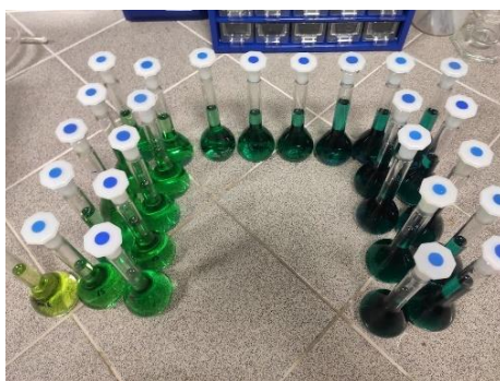
Obr. 33: Vybarvení kalibrační řady za použití Berthelotovy metody
