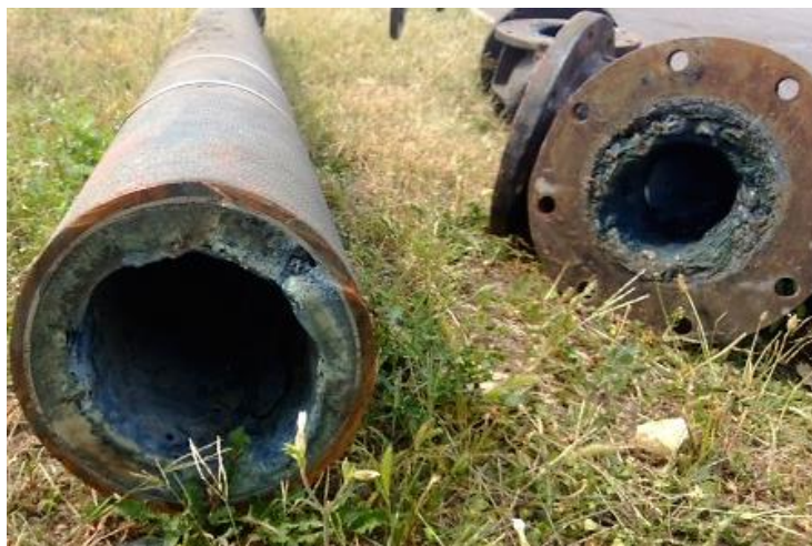
Obr. 4: Potrubí se struvitem [22]
