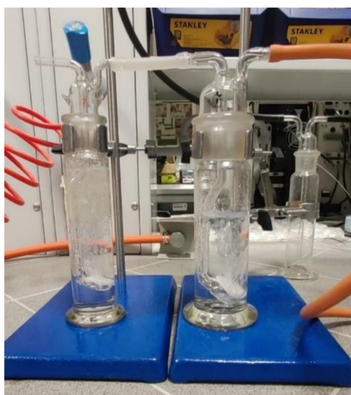
Obr. 9: Stripování – technické provedení
