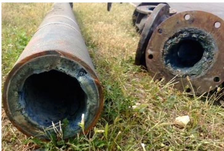
Obr. 4: Potrubí se struvitem [22]
