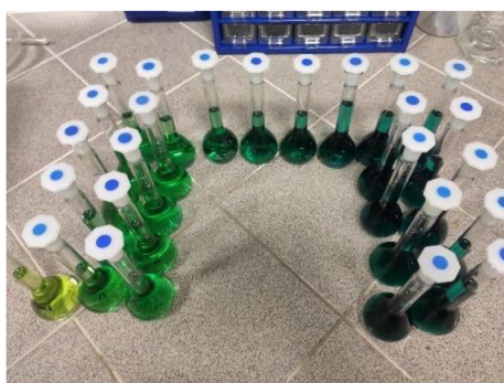
Obr. 33: Vybarvení kalibrační řady za použití Berthelotovy metody
