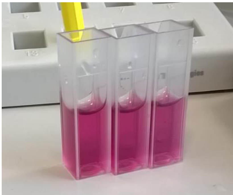
Obr. 4: Barevný produkt vzniklý oxidací 3,5-dichloro-2-hydroxybenzensulfonatu sodného a aminoantipyrinu pomocí křenové peroxidasy.
