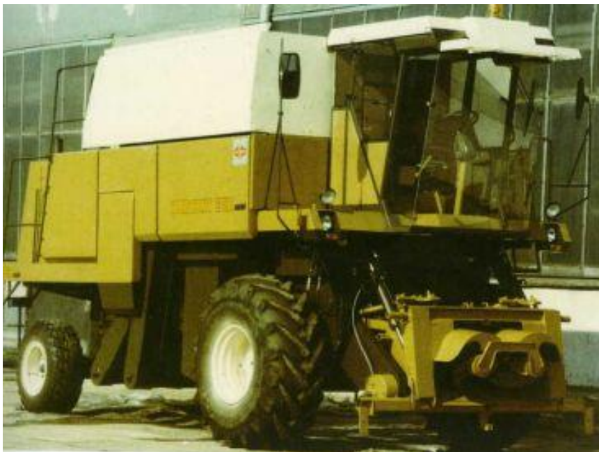
Obrázek 4: Fortschritt E-532 prototyp s axiálním mláticím ústrojím [11]
