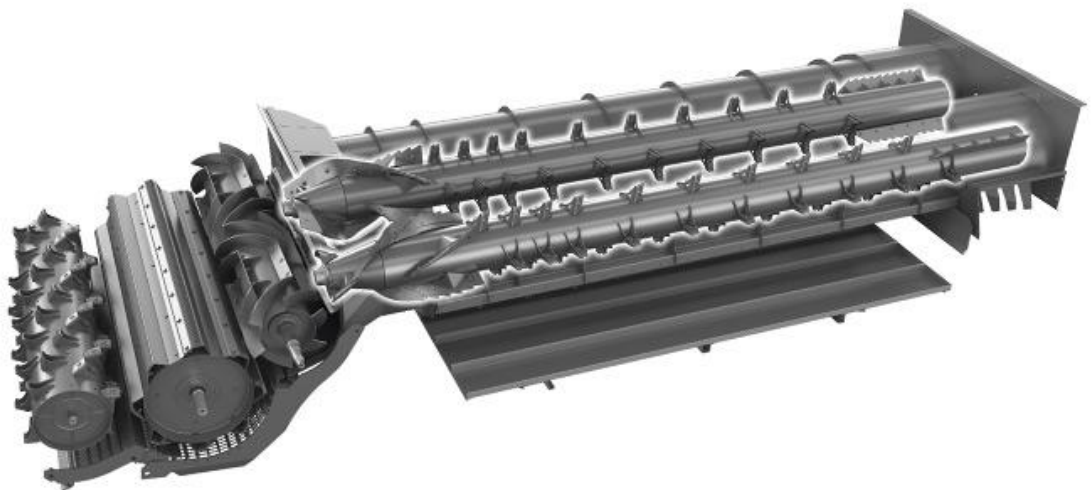
Obrázek 12: Hybridní mláticí ústrojí ROTOR HYBRID SYSTÉM firmy Claas [1]
