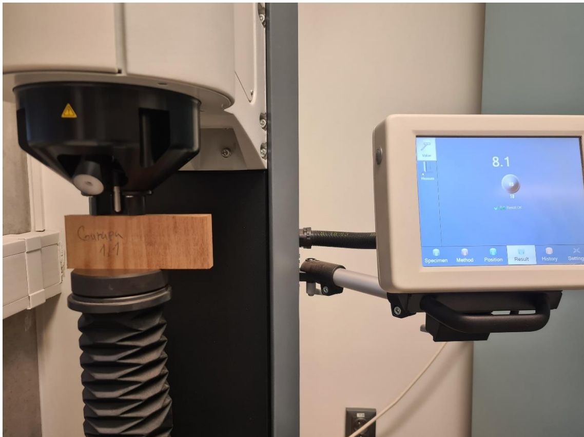
Obrázek 12. Měření tvrdosti vzorku garapa (vlastní foto)
