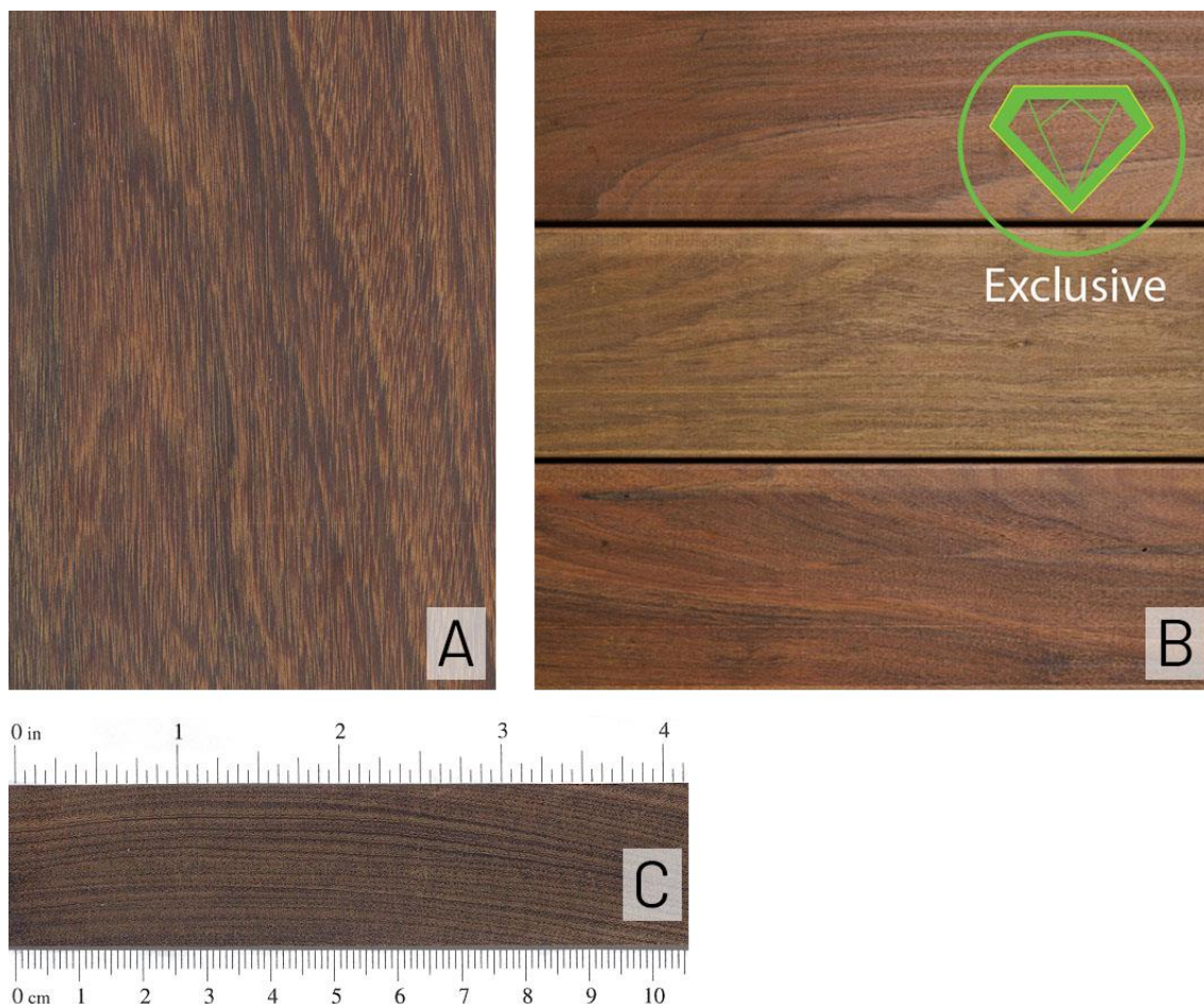
Obrázek 5. Makroskopická stavba Handroanthus spp. A – tangenciální řez (wood-database, 2022), B – terasová prkna (DLH Hrdina s. r. o.), C – transverzální řez (wood-database, 2022)
