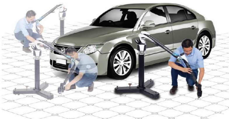
Obrázek 11: Mřížka zapuštěných prohlubní pro určení polohy ramene po přískoku (spol. Hexagon) [10]
