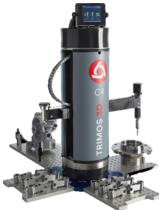
Obrázek 3: Přípravky pro měření více dílů v jedné operaci [27]
