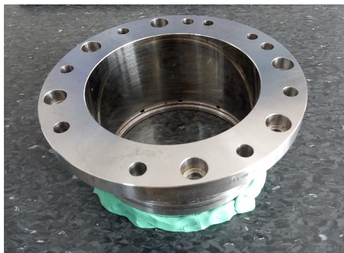
Obrázek 27: Upnutí součásti pomocí plastické hmoty
