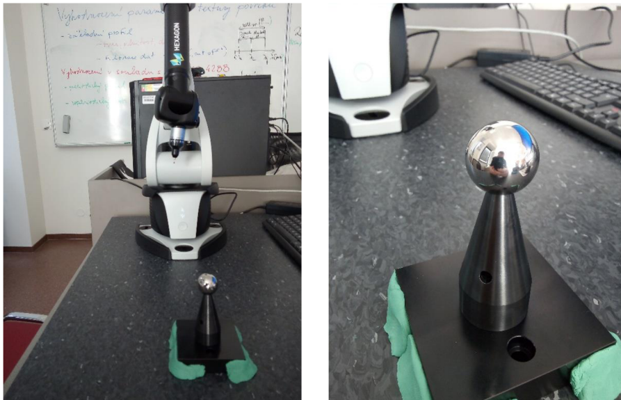
Obrázek 29: Sestava pro ověření rozměru kalibrované koule
