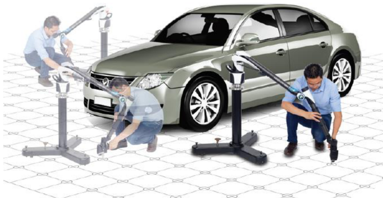
Obrázek 11: Mřížka zapuštěných prohlubní pro určení polohy ramene po přiskoku (spol. Hexagon) [10]
