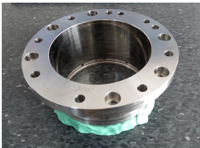
Obrázek 27: Upnutí součásti pomocí plastické hmoty
