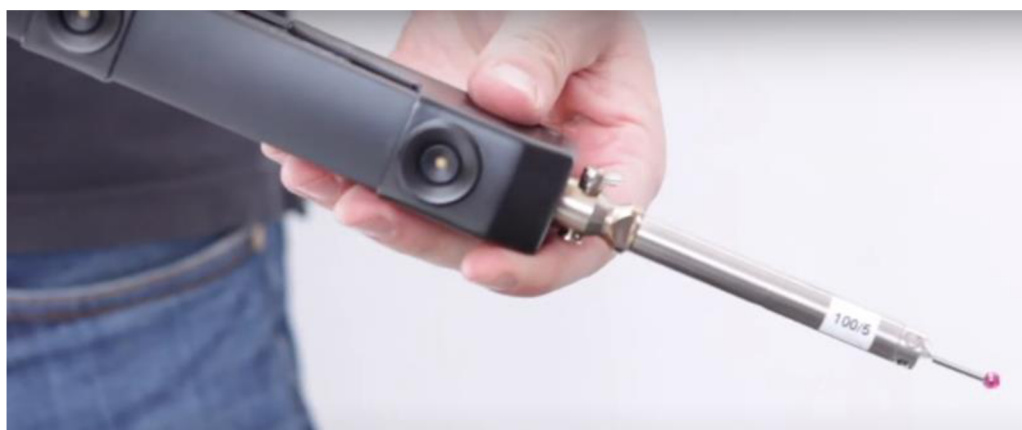
Obrázek 5: Sonda pro měření hlubokých úzkých děr (Metronor) [31]
