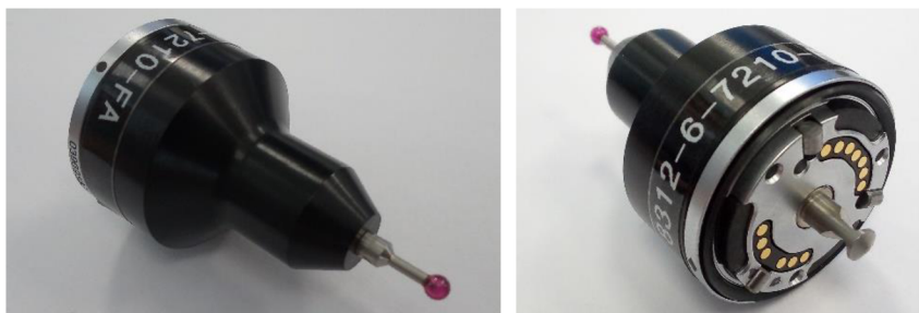
Obrázek 25: Použitá sonda s 3 mm hrotem
