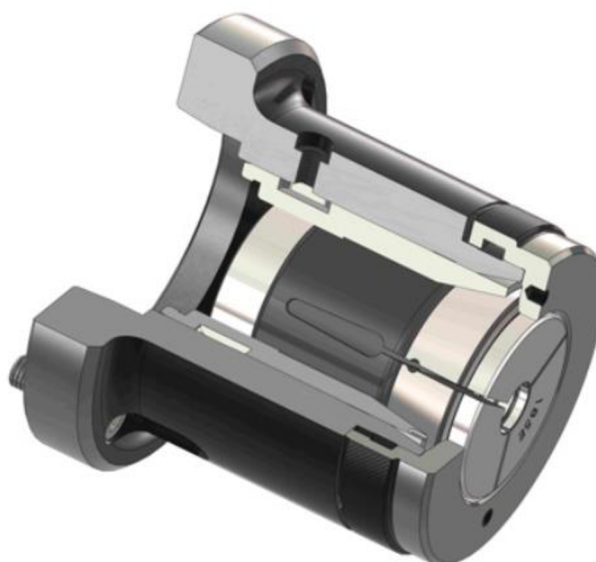
Obr. 2-10 Tlačná kleština s upínačem [12]
