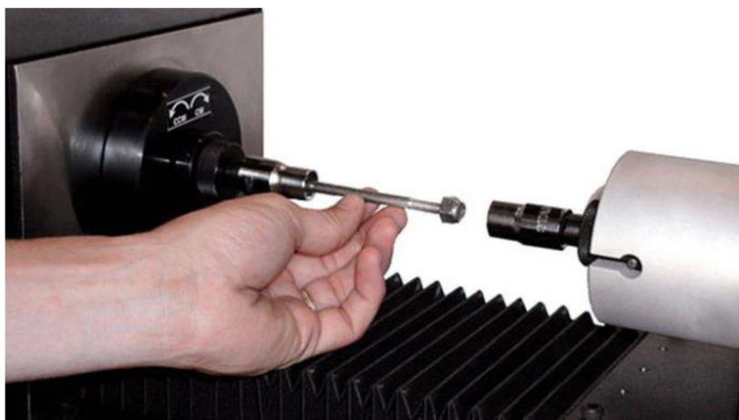
Obr. 2-12 Nástrčné hlavice pro upnutí vzorku [14]
