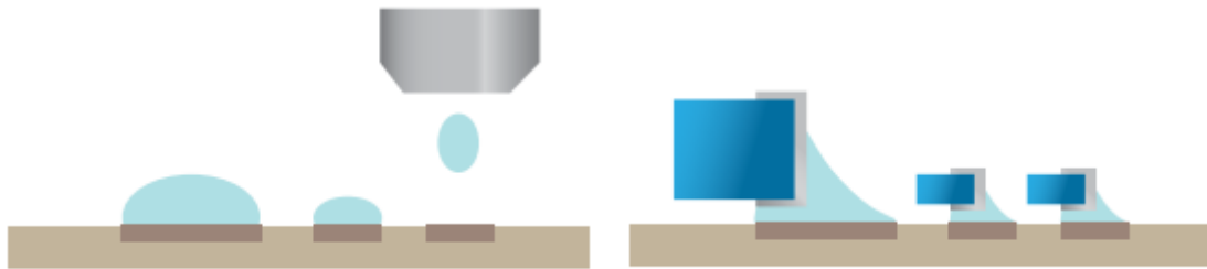
Obr. 13: Princip nanášení pasty dispenzerem – na obrázku je vidět rozdílné nastavení množství nanášené pasty pro jednotlivé součástky [7]
