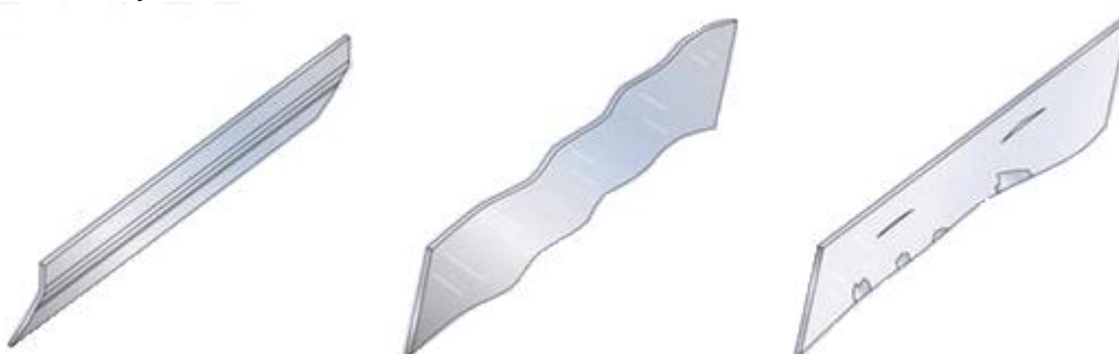
Obr. 10: Defekty kovových stěrek- ohnutá, zvlněná a popraskaná
