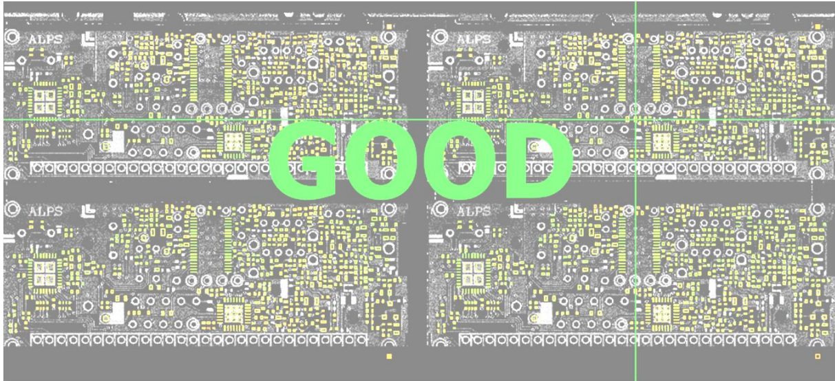
Obr. 35: Rozložení množství pasty na DPS z linky 10
