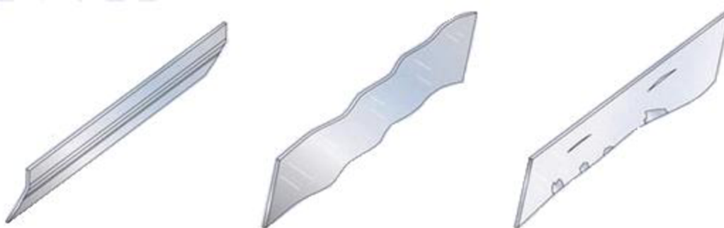
Obr. 10: Defekty kovových stěrek- ohnutá, zvlněná a popraskaná
