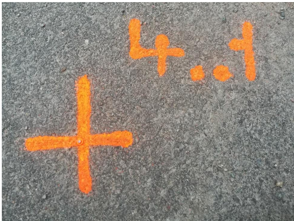
Obr. 2 Bod pomocnej meračskej siete 4001 Zdroj: Vlastný
