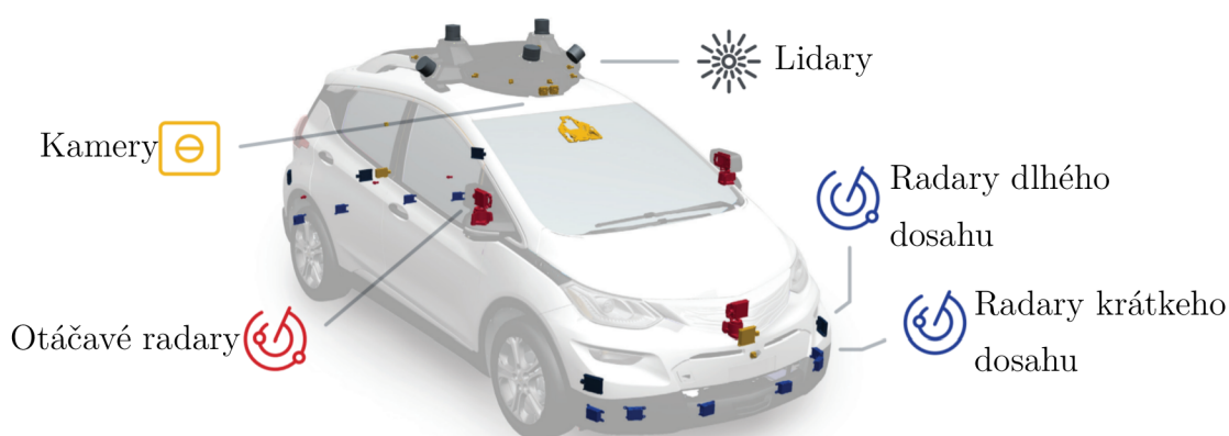
Obr. 5.5: Rozloženie senzorov na Cruise AV (Chevrolet Bolt) [53]
