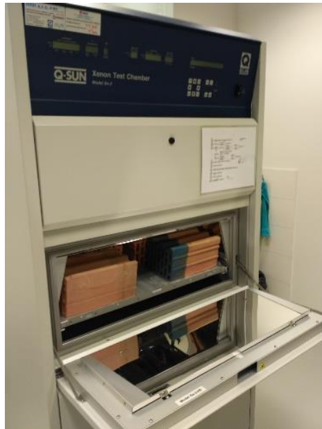
Obr. 16 Komora Qsun pro simulaci stárnutí vlivem UV záření
