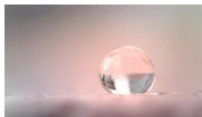
Obr. 27 Voda na hydrofobizovaném zdícím prvku
