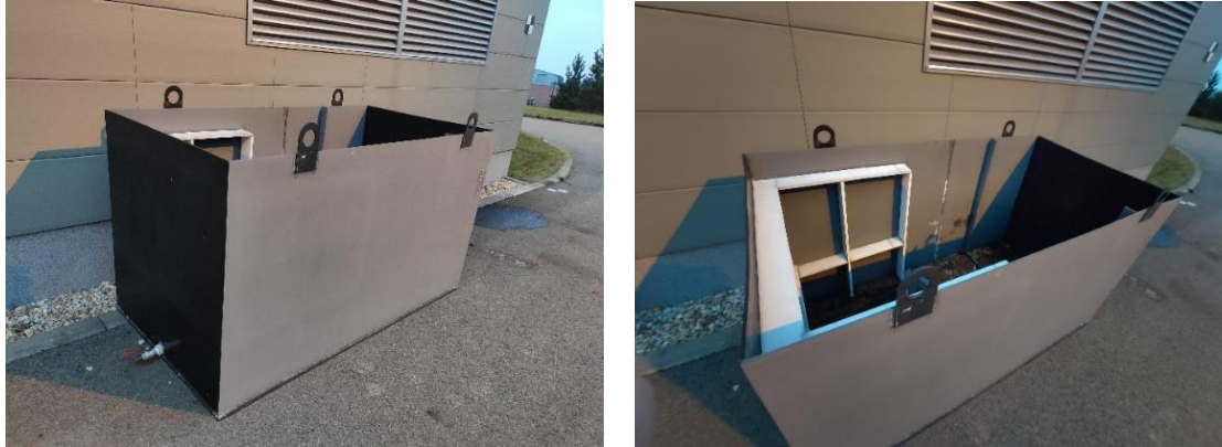
Obr. 20 Nádrž pro provedení zátopové zkoušky
