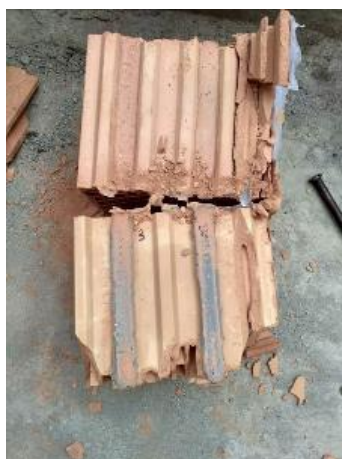
Obr. 39 Obr. 20: Styčná spára - Izolační tmel
