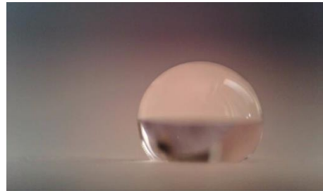
Obr. 61 Voda na hydrofobizovaném zdícím prvku silan-siloxanovou mikroemulzí
