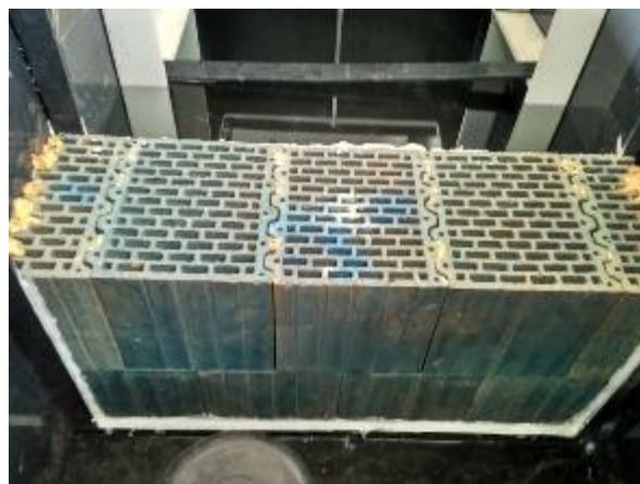
Obr. 57 Lícová strana konstrukce ze suché strany po 14 dnech zatížení vodou
