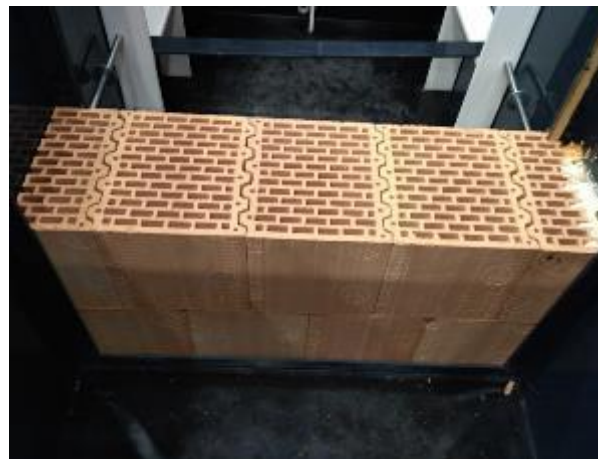
Obr. 47 Lícová strana konstrukce ze suché strany před zatopením vodou
