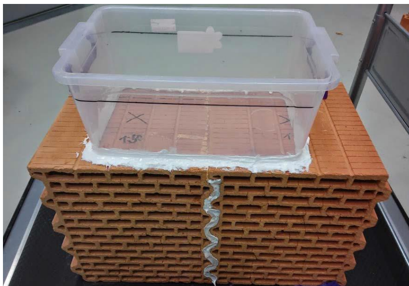
Obr. 18 Ověření vodotěsnosti styčné spáry pojené zdící pěnou
