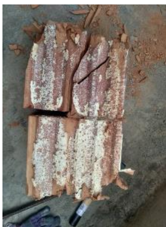
Obr. 41 Styčná spára - Studniční PUR pěna
