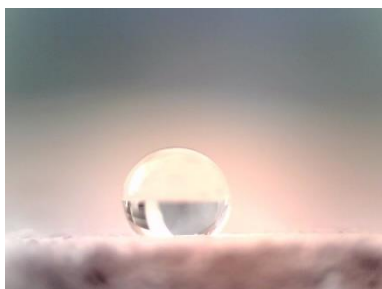
Obr. 28 Voda na tvarovce ošetřené ASSXM 1:40 (úhel smáčivosti 134,2 °)
