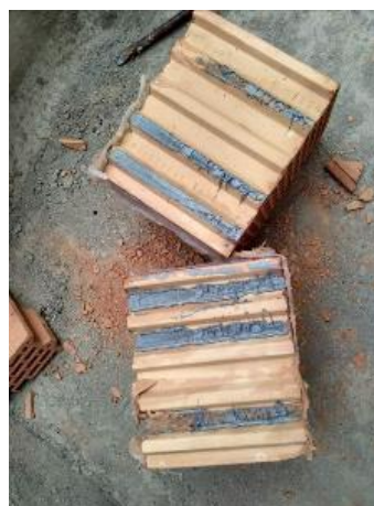
Obr. 40 Styčná spára - Stavbařský tmel
