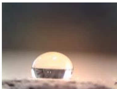
Obr. 23 Glycerol na referenčním tvarovce (úhel smáčivosti 105,3 °)
