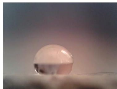
Obr. 30 Ethyleneglykol na tvarovce ošetřené ASSXM 1:40 (úhel smáčivosti 122,5 °)
