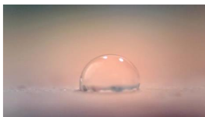
Obr. 26 Voda na nehydrofobizovaném zdícím prvku
