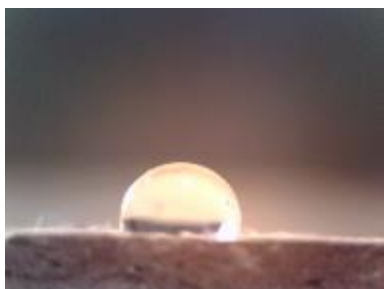
Obr. 22 Voda na referenčním tvarovce (úhel smáčivosti 103,0 °)
