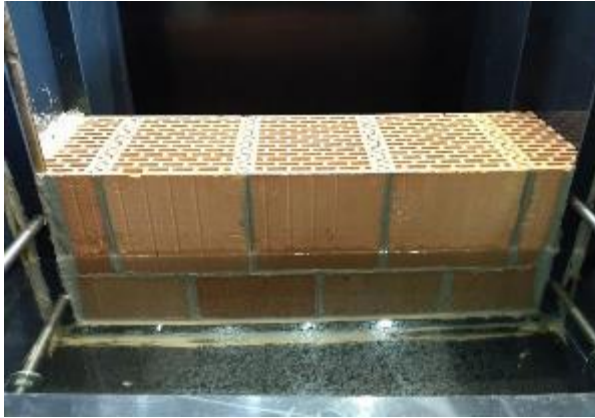
Obr. 48 Lícová strana konstrukce z mokré strany po 21 dnech zatopení vodou
