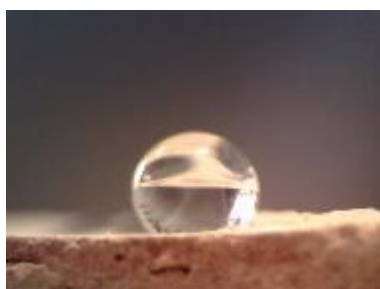
Obr. 32 Glycerol na tvarovce ošetřené SIM 1:40 (úhel smáčivosti 130,2 °)
