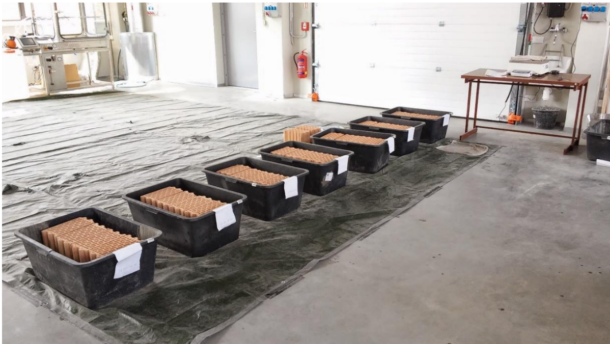
Obr. 15 Stanovení kapilární absorpce
