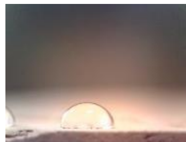
Obr. 24 Ethyleneglykol na referenčním tvarovce (úhel smáčivosti 81,6 °)
