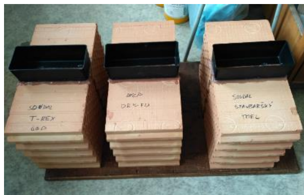
Obr. 38 Ověření vodotěsnosti styčné spáry pálených zdících prvků
