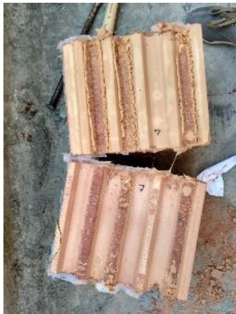
Obr. 43 Styčná spára - Zdicí PUR pěna Dryfix
