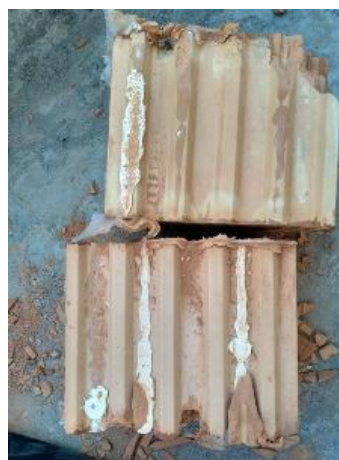
Obr. 42 Styčná spára - Lepicí tmel
