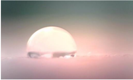
Obr. 60 Voda na nehydrofobizovaném zdícím prvku
