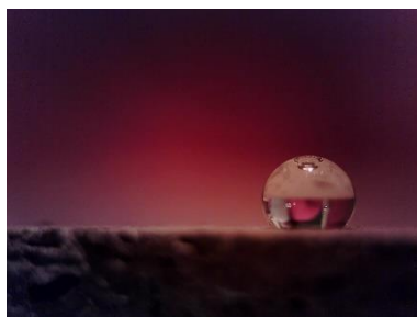
Obr. 29 Glycerol na tvarovce ošetřené ASSXM 1:40 (úhel smáčivosti 128,5 °)
