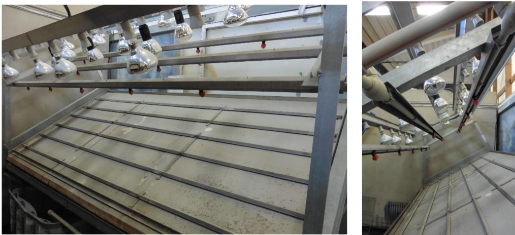
Obr. 17 Zařízení pro zrychlený test stárnutí - skrápědlo
