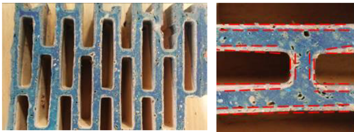
Obr. 36 Stanovení hloubky hydrofobizační ochrany
