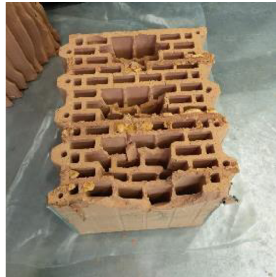
Obr. 51 Tvarovka po odebrání vzorků pro stanovení vlhkostních profilů
