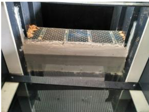
Obr. 56 Lícová strana konstrukce z mokré strany po 14 dnech zatížení vodou
