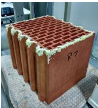
Obr. 34 Referenční zdící prvek po 30 dnech namáhání zvýšenou vlhkostí
