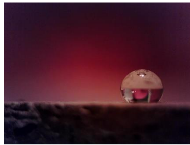
Obr. 29 Glycerol na tvarovce ošetřené ASSXM 1:40 (úhel smáčivosti 128,5 °)
