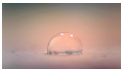
Obr. 26 Voda na nehydrofobizovaném zdícím prvku
