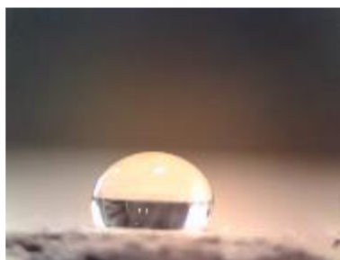
Obr. 23 Glycerol na referenčním tvarovce (úhel smáčivosti 105,3 °)
