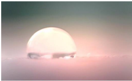
Obr. 60 Voda na nehydrofobizovaném zdícím prvku
