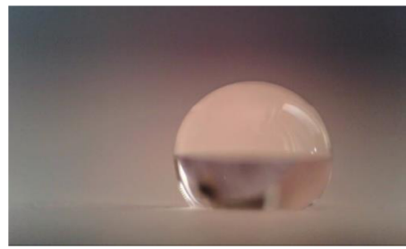
Obr. 61 Voda na hydrofobizovaném zdícím prvku silan-siloxanovou mikroemulzí
