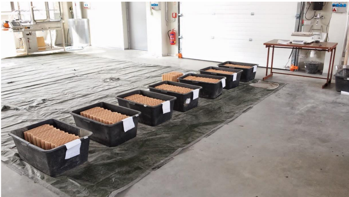
Obr. 15 Stanovení kapilární absorpce
