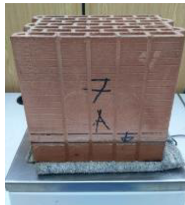
Obr. 35 Hydrofobizovaný zdící prvek po 27 měsících kontinuálního namáhání zvýšenou vlhkostí
