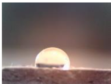
Obr. 22 Voda na referenčním tvarovce (úhel smáčivosti 103,0 °)
