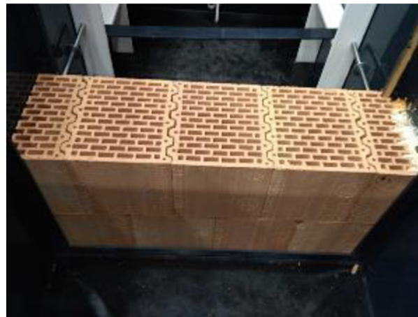
Obr. 47 Lícová strana konstrukce ze suché strany před zatopením vodou
