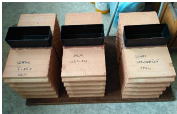
Obr. 38 Ověření vodotěsnosti styčné spáry pálených zdících prvků
