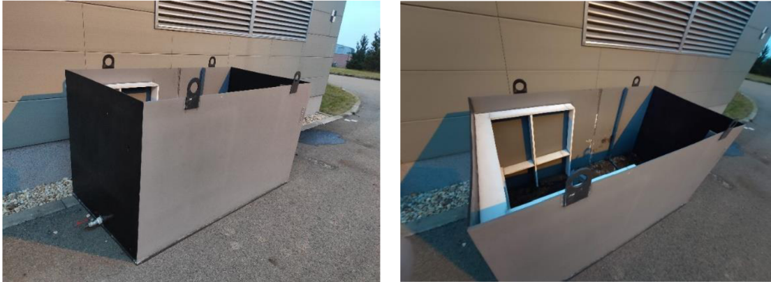
Obr. 20 Nádrž pro provedení zátopové zkoušky
