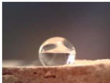
Obr. 32 Glycerol na tvarovce ošetřené SIM 1:40 (úhel smáčivosti 130,2 °)
