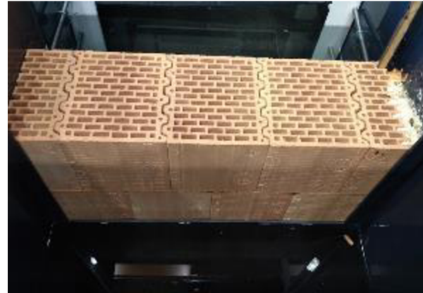
Obr. 49 Lícová strana konstrukce z mokré strany po 21 dnech zatopení vodou
