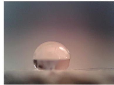
Obr. 30 Ethyleneglykol na tvarovce ošetřené ASSXM 1:40 (úhel smáčivosti 122,5 °)
