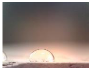
Obr. 24 Ethyleneglykol na referenčním tvarovce (úhel smáčivosti 81,6 °)
