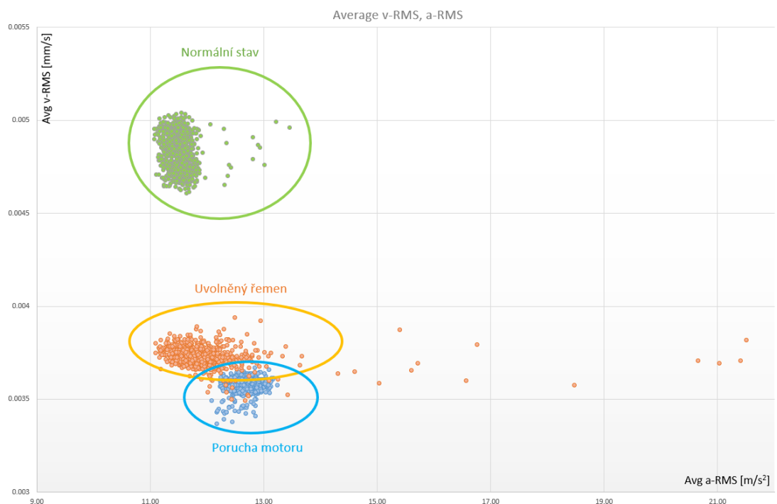
Obr 20 – Porovnání poruchových hodnot s bezporuchovým stavem a-RMS, v-RMS
