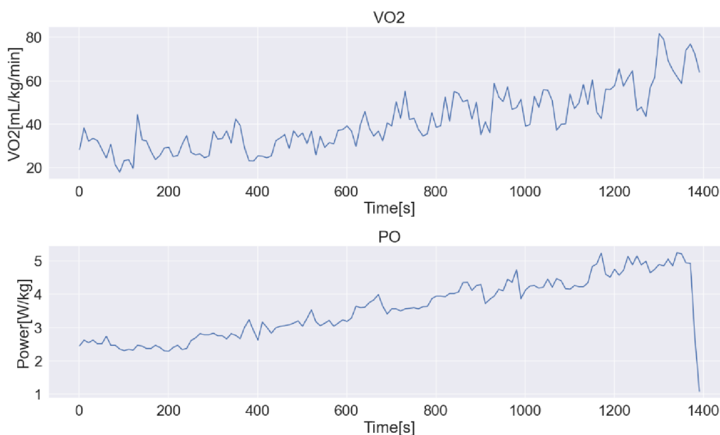
Obr. 20 Kolísání VO_2 a PO ve vnějším prostředí vlivem větru
