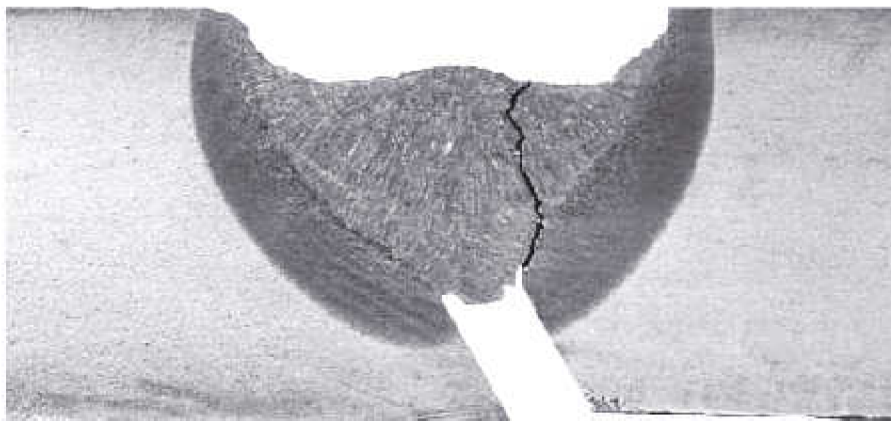
Obr. 39 Studená trhlinka šířící se od hranice natavení [31]
