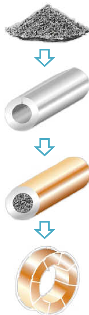
Obr. 31 Výroba plněných elektrod [26]
