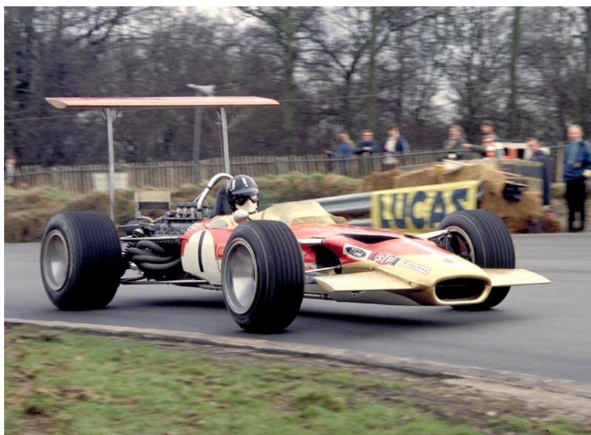
Obr. 3.22 Monopost Lotus 49 s přitlačným křídlem [44]
