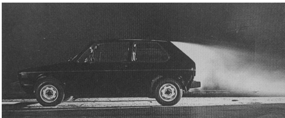
Obr. 1.2 Zobrazení oblasti úplavu u vozu Volkswagen Golf 1 [1]
