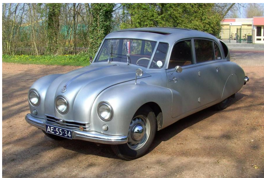
Obr. 3.2 Přepracovaná před' se zapuštěnými světlometry vozu Tatra 87 [16]
