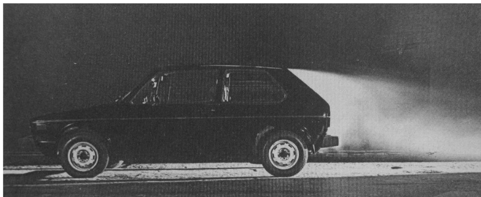
Obr. 1.2 Zobrazení oblasti úplavu u vozu Volkswagen Golf 1 [1]
