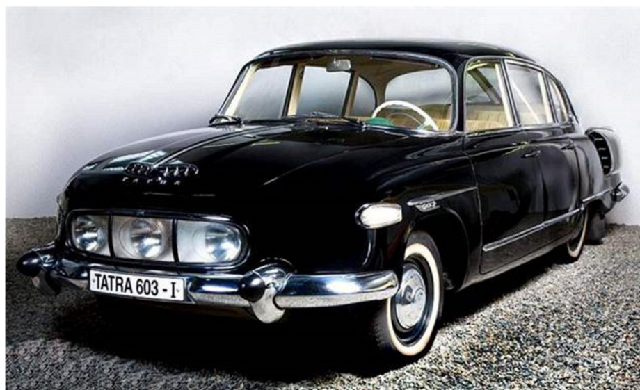
Obr. 3.8 První verze vozu Tatra 603 s třemi světlomety pod plastovým krytem [27]
