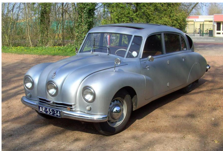
Obr. 3.2 Přepracovaná před se zapuštěnými světlomety vozu Tatra 87 [16]
