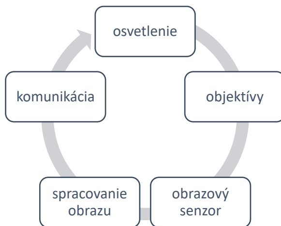
Obr. 1: Blokový diagram pre typickú prevádzku vizuálneho systému
