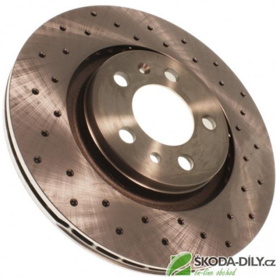
Obr.7 Přední brzdový kotouč větraný děrovaný Ferodo Škoda Octavia [25]
