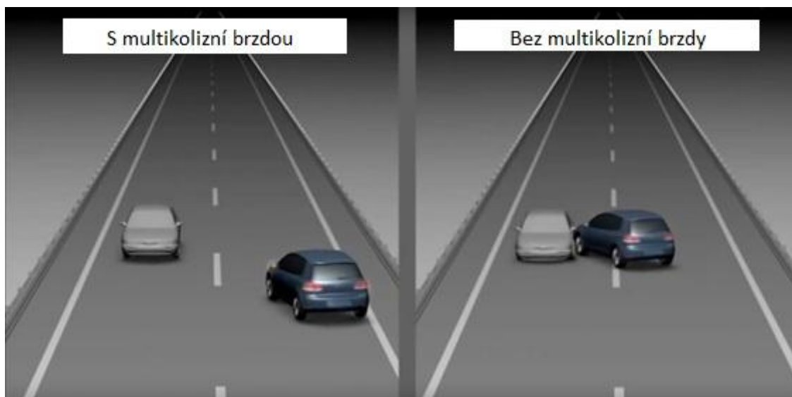
Obr.30 Ukázka přínosu multikolizní brzdy. Po první kolizi vozidlo autonomně zabrzdí a neohrozí protisměrný provoz [35]
