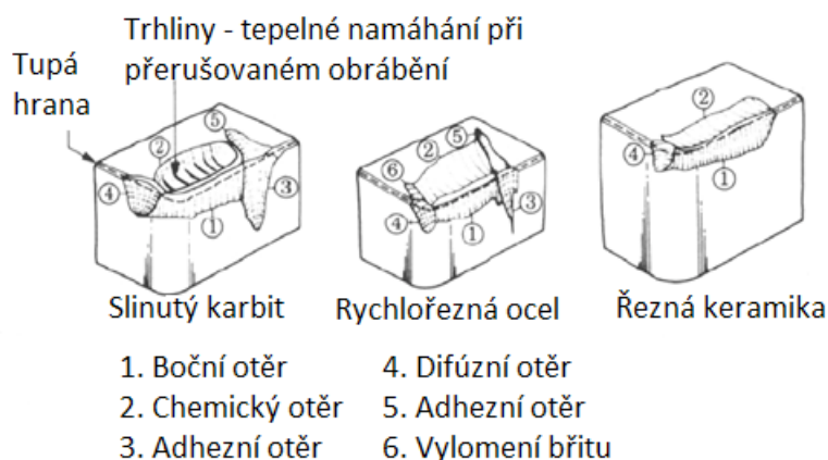
[Obr. 5] – Poškození břitových destiček [7]
