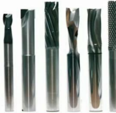
[Obr. 11] – Ukázka monolitních fréz na obrábění kompozitů [14]
