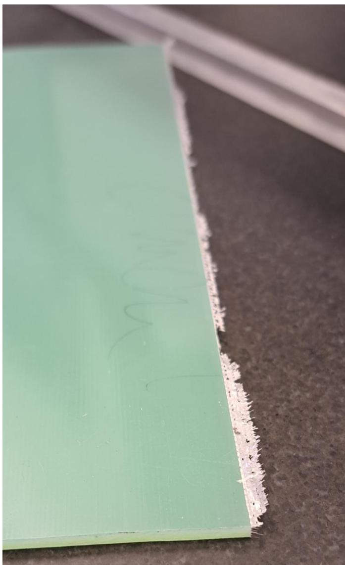
Obr. 27 Ukázka delaminace (po skončení 3. cyklu)
