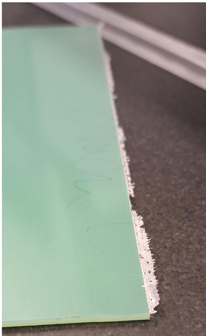
Obr. 27 Ukázka delaminace (po skončení 3. cyklu)
