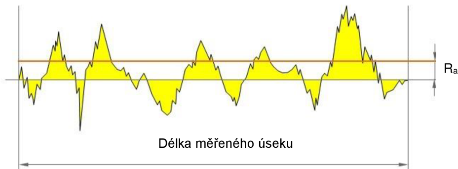
[Obr. 8] – Příklad naměřeného profilu a vyhodnocení R_a [11]
