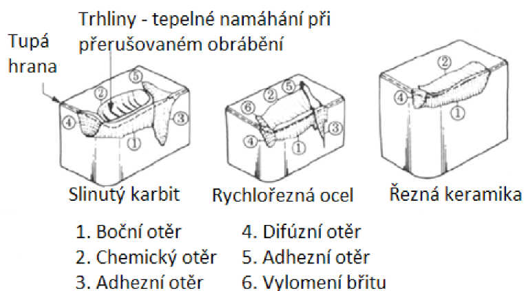
[Obr. 5] – Poškození břitových destiček [7]
