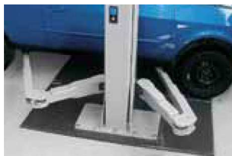
Obr. 32: Dvoukloubová ramena zvedáku TM 250 DG
