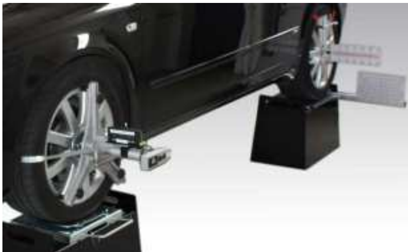
Obr. 17: Zařízení pro měření geometrie podvozku WMS Carline CL20
