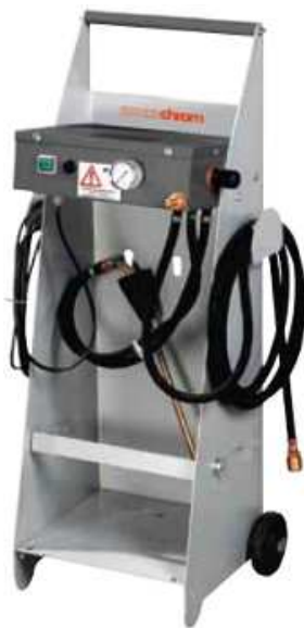
Obr. 28: Elektronické zařízení na testování a odvzdušňování brzd
