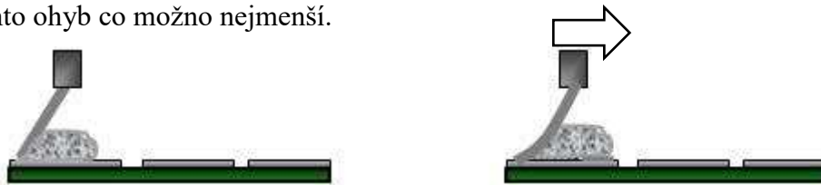
Obrázek 24: Změna úhlu těrky během tisku pájecí pasty [13]
