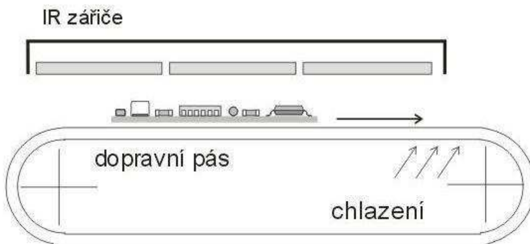
Obrázek 7: Jednoduchý model přetavovací pece využívající IR záření [5]
