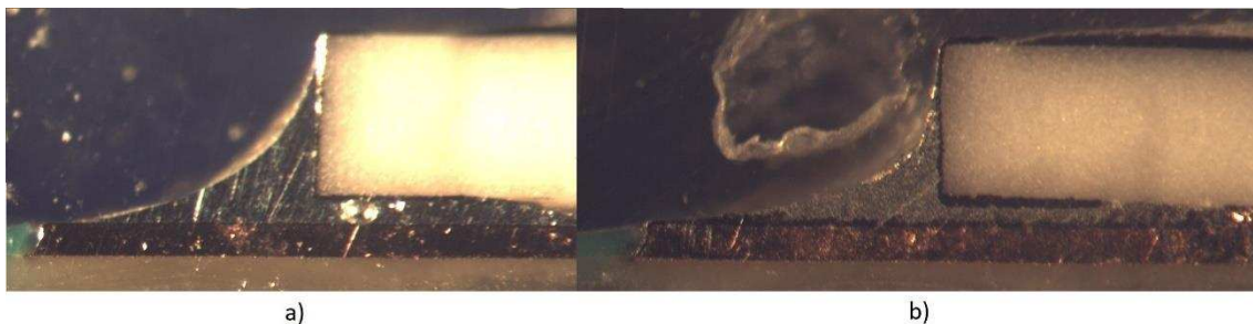
Obrázek 102: Změna struktury spoje a) před teplotním cyklováním, b) po teplotním cyklování
