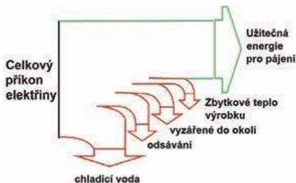
Obrázek 4: Schéma proudění energie u konvekční pájecí pece [4]
