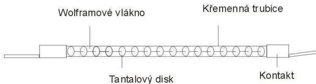
Obrázek 6: Konstrukční provedení wolframového zářiče [5]
