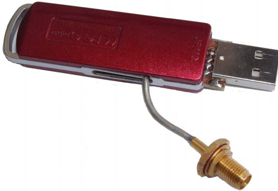
Obr. 5.2: Model antény v plastovém krytu
