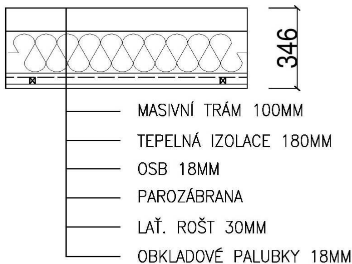
Obr. 10 Skladba roubené pasivní stěny
