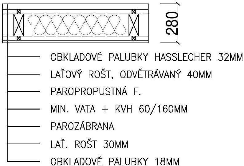
Obr. 5 Skladba stěny v obývacím pokoji
