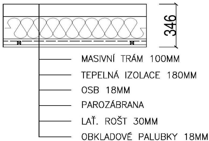
Obr. 9 Skladba stěny pasivní rámové konstrukce
