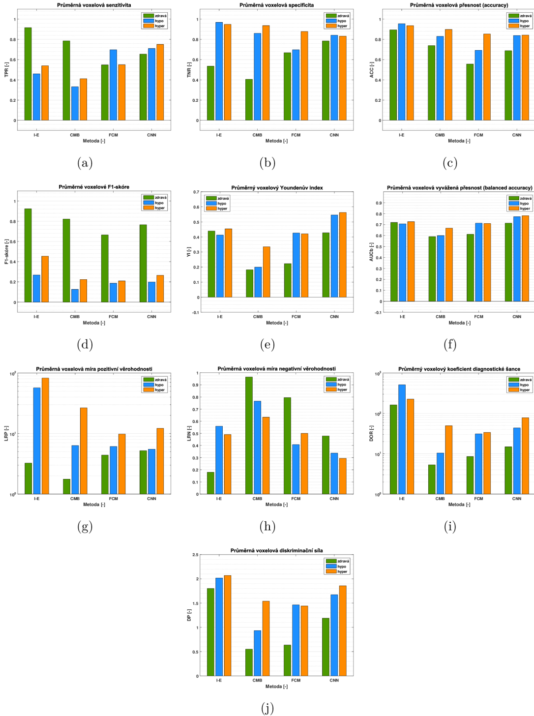
Obr. 5.1: Porovnání dosažených průměrných výsledků podle voxelově založené metody (Kap. 4.6.1): senzitivita (a), specifita (b), správnost (c), F1-skóre (d), Youdenův index (e), vyvážená správnost (f), míra pozitivní věrohodnosti (g), míra negativní věrohodnosti (h), koeficient diagnostické šance (i) a diskriminační síla (j) (na ose x jsou navrženy metody CMB , FCM a CNN , I-E vyjadřuje mezi-expertní hodnoty, jednotlivé sloupce vyjadřují typ klasifikované tkáně).
