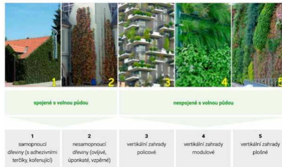
Obr. 4 Základní rozdělení zelených fasád (Burian 2022)
