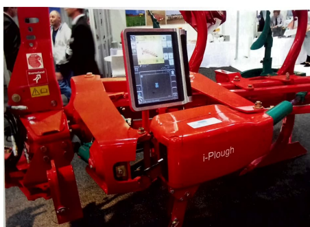
Obrázek 5.9: Dělená závěsná hlava (Fuka, 2017)
