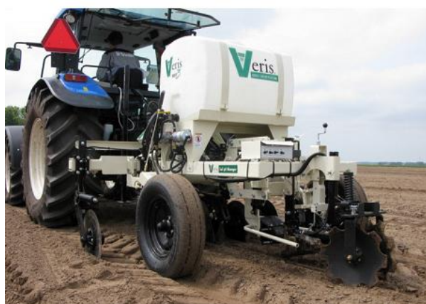
Obrázek 3.18: Mobilní senzorová platforma Veris MSP (LeadingFarmers, 2021)
