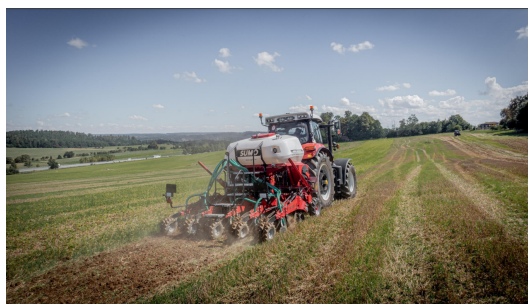
Obrázek 5.1: Strip-till technologie setí pomocí stroje SUMO DTS do předem nezpracované půdy (Mádl, 2022a)
