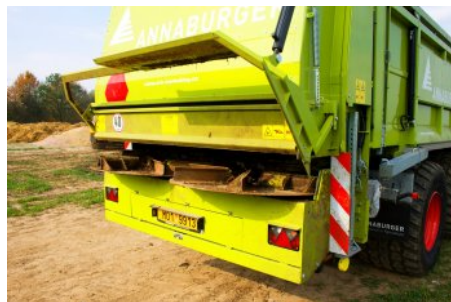
Obrázek 6.3: Rozmetací ústrojí vybavené clonou pro hraniční hnojení (Jedlička, 2019)
