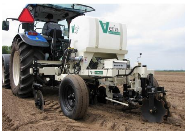
Obrázek 3.18: Mobilní sensorová platforma Veris MSP (LeadingFarmers, 2021)
