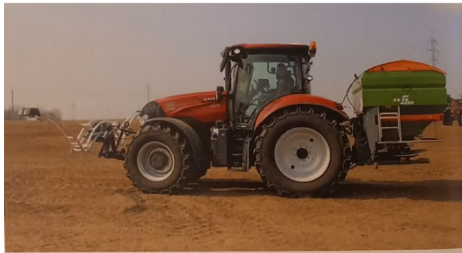
Obrázek 6.1: Souprava pro variabilní hnojení minerálními hnojivy (Beneš, 2019a)
