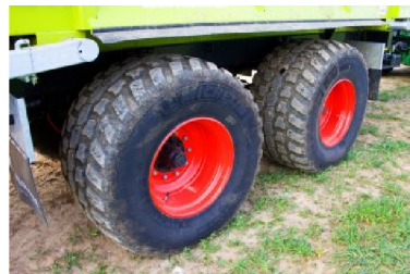
Obrázek 6.2: Nízkotlaké pneumatiky s ventilky pro změnu tlaku (Jedlička, 2019)
