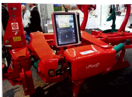
Obrázek 5.9: Dělená závěsná hlava (Fuka, 2017)
