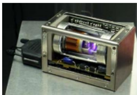
Obrázek 3.3: Atomové hodiny (Walterová a Ondráková, 2022)
