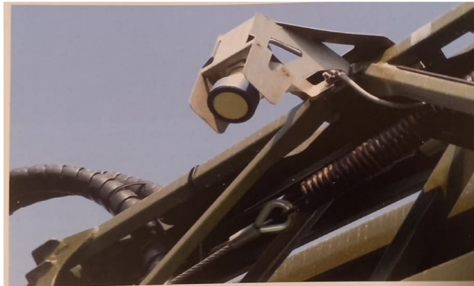
Obrázek 4.4: Ultrazvukový senzor zajišťující konstantní výšku nad porostem (Karásková, 2018a)
